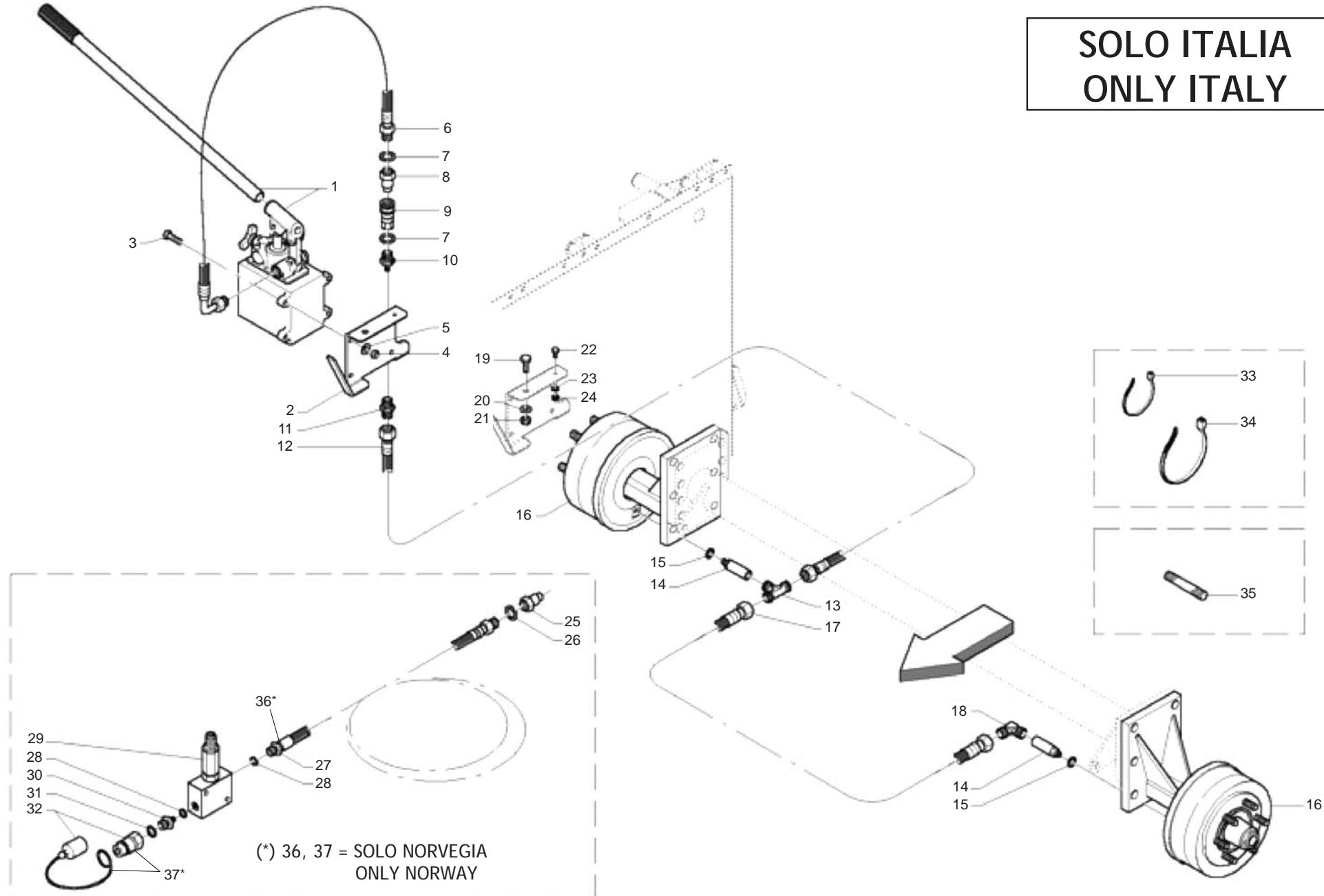
**DISPOSITIVO DI STAZIONAMENTO IDRAULICO (CUT)**
