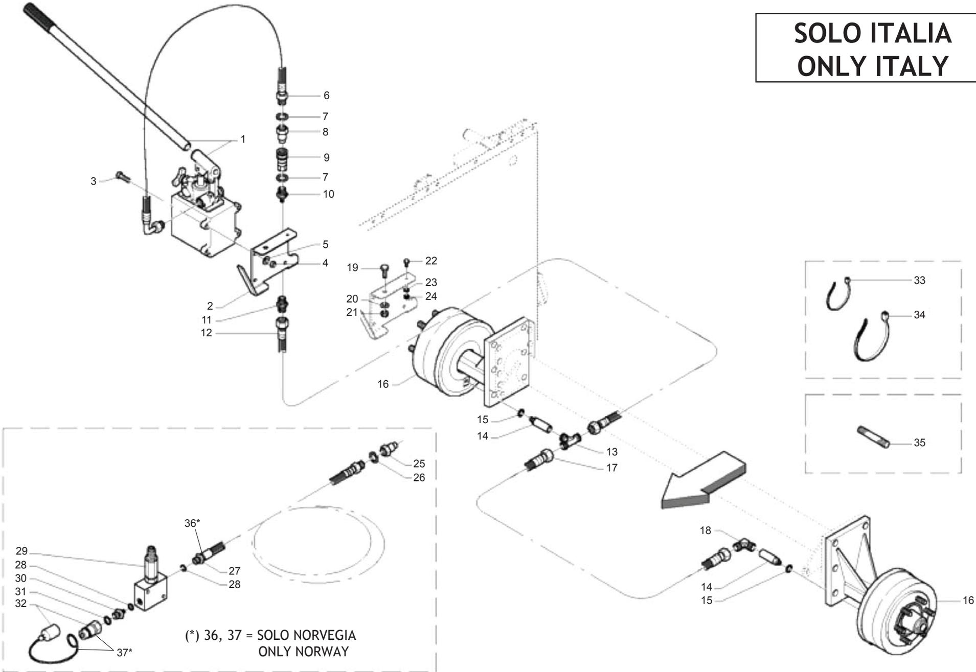
**DISPOSITIVO DI STAZIONAMENTO IDRAULICO (CUT)
