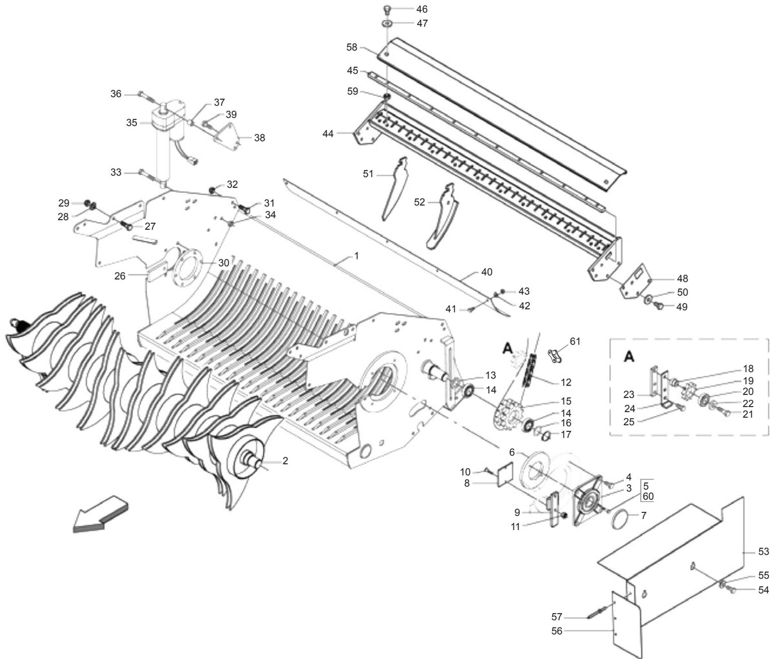
**CUT 13: TELAIO + ROTORE**
