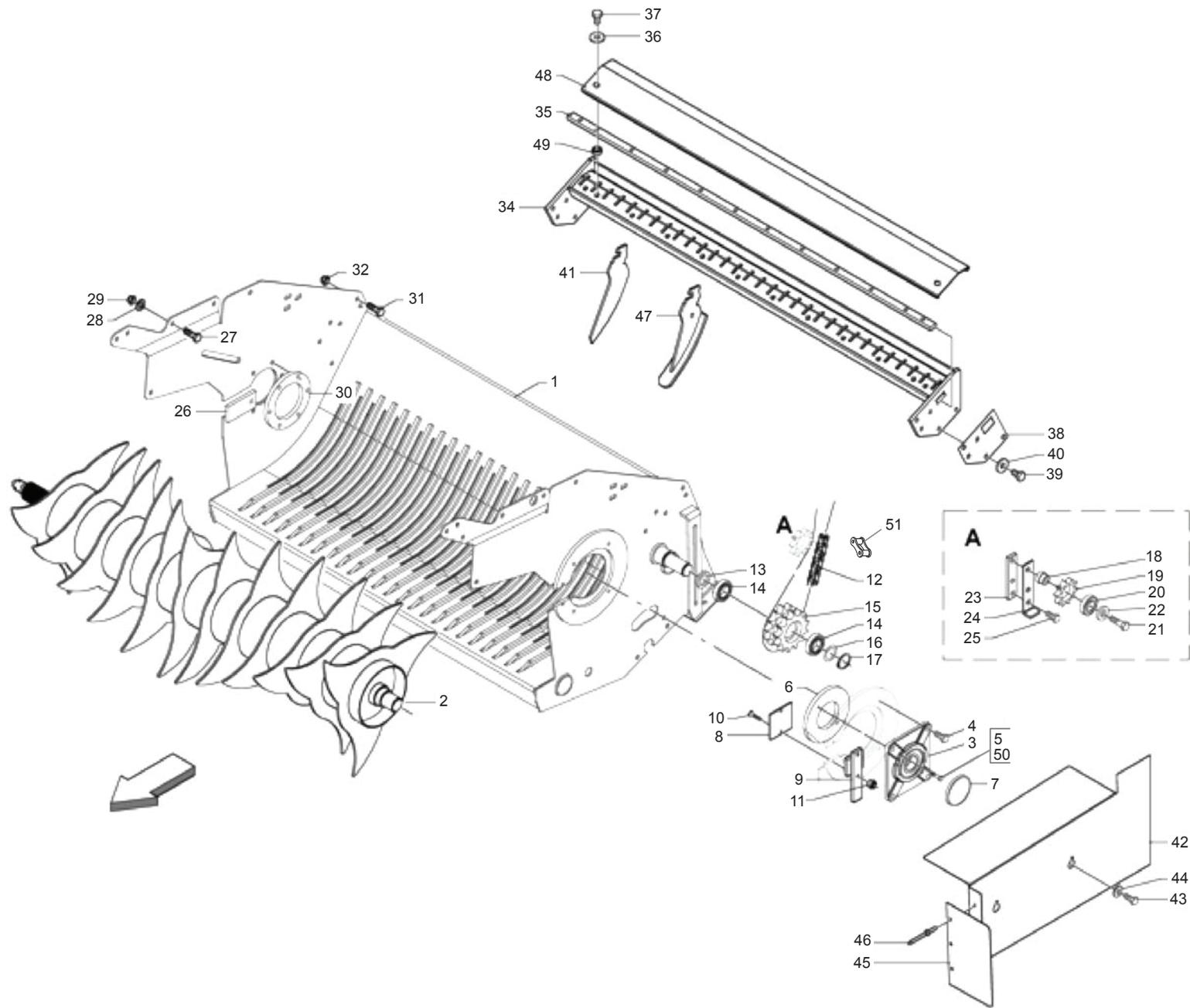
**ROTOR: TELAIO + ROTORE**
