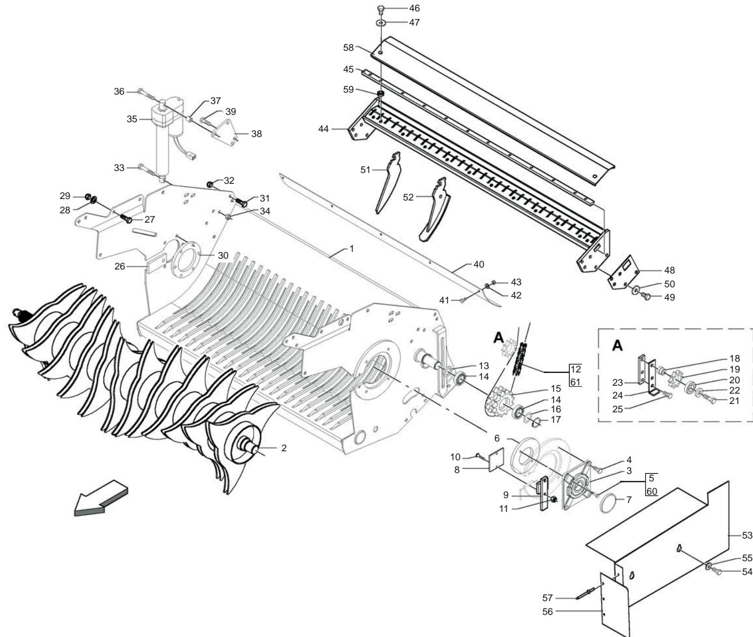
**CUT 13: TELAIO + ROTORE**
