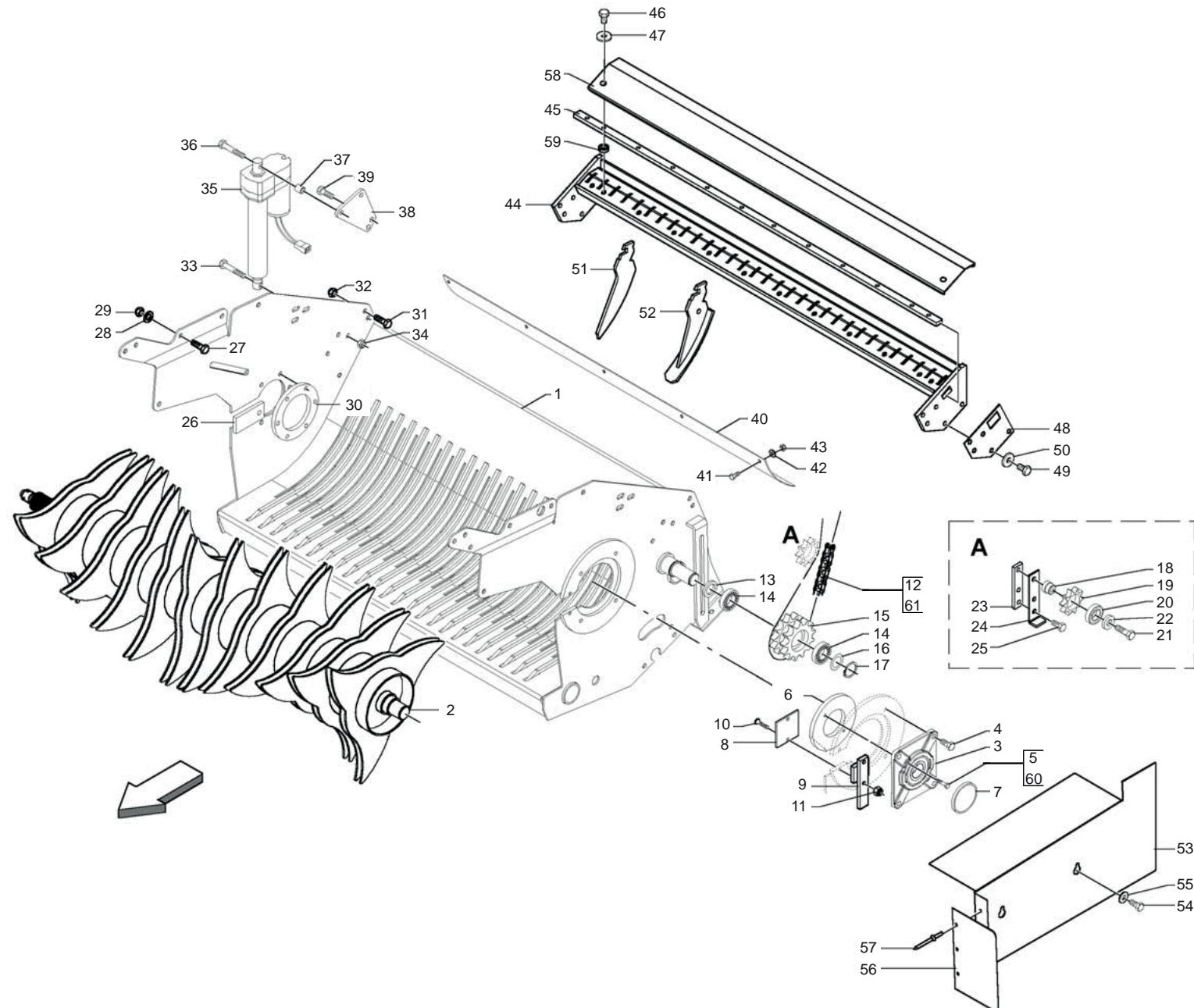
**CUT 13: TELAIO + ROTORE**
