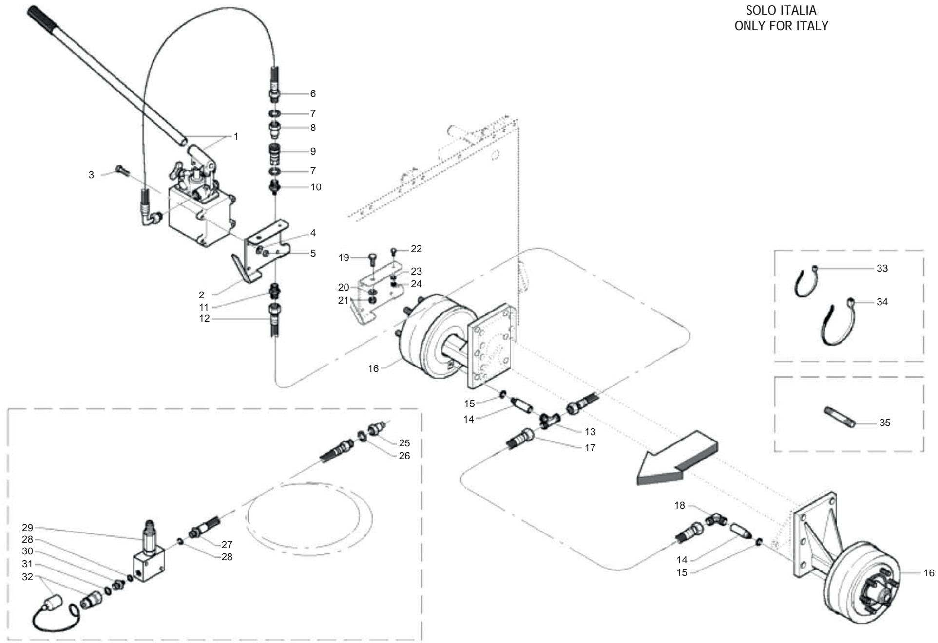
**DISPOSITIVO STAZIONAMENTO IDRAULICO (CUT)**
