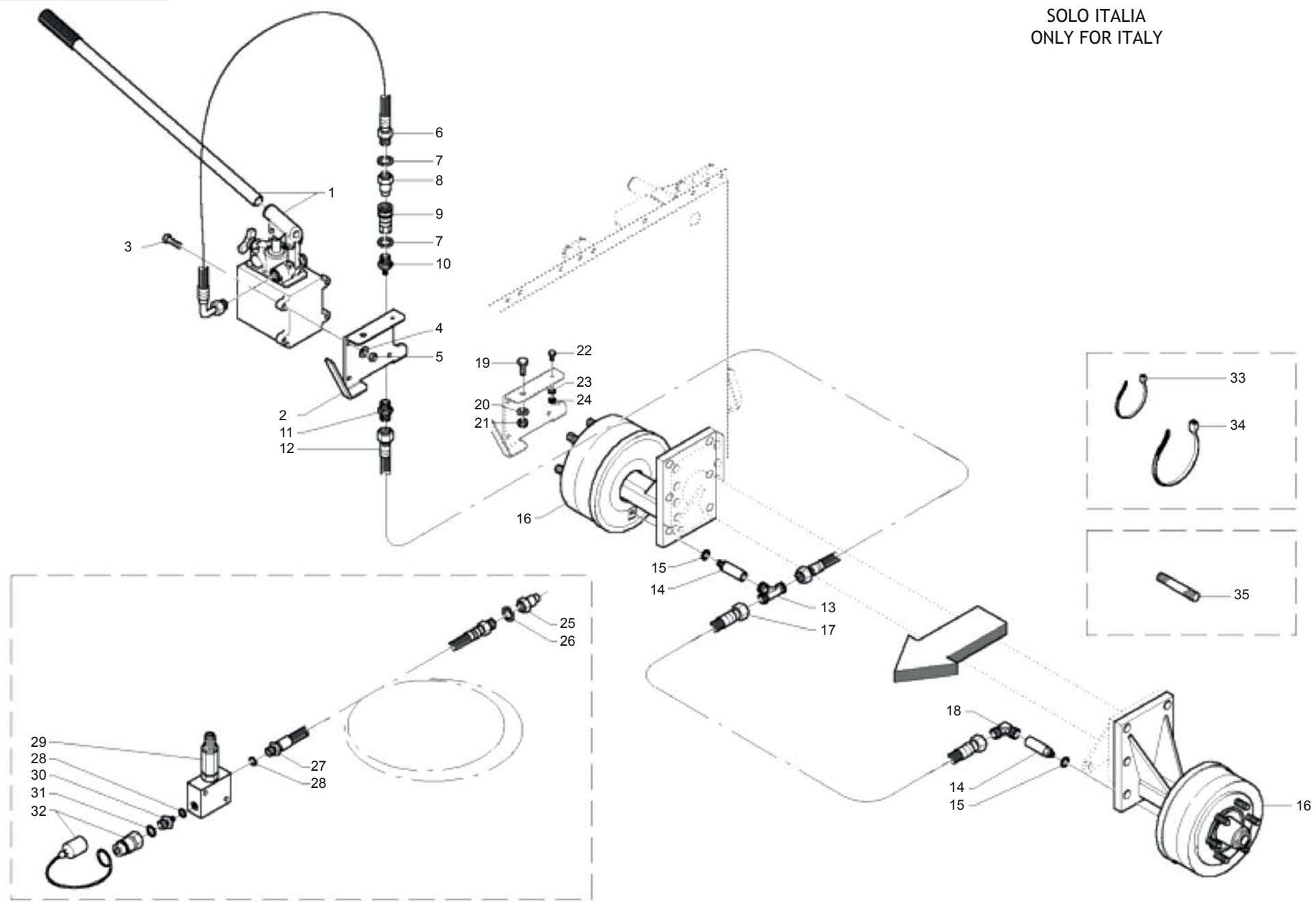
**DISPOSITIVO STAZIONAMENTO IDRAULICO (CUT)**
