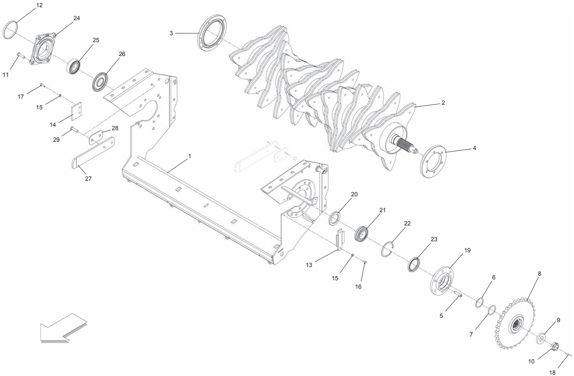
**CUT 15: TELAIO + ROTORE**
