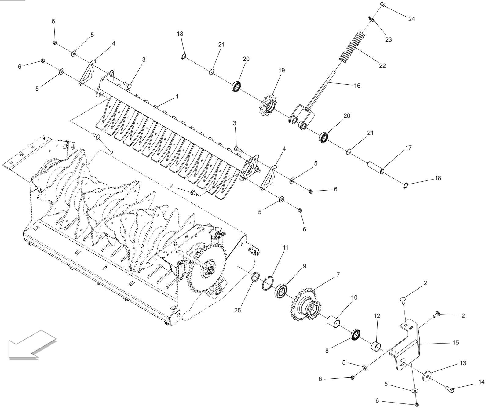
**ROTOR: BARRA RASCHIATORE + PORTA SENSORE**
