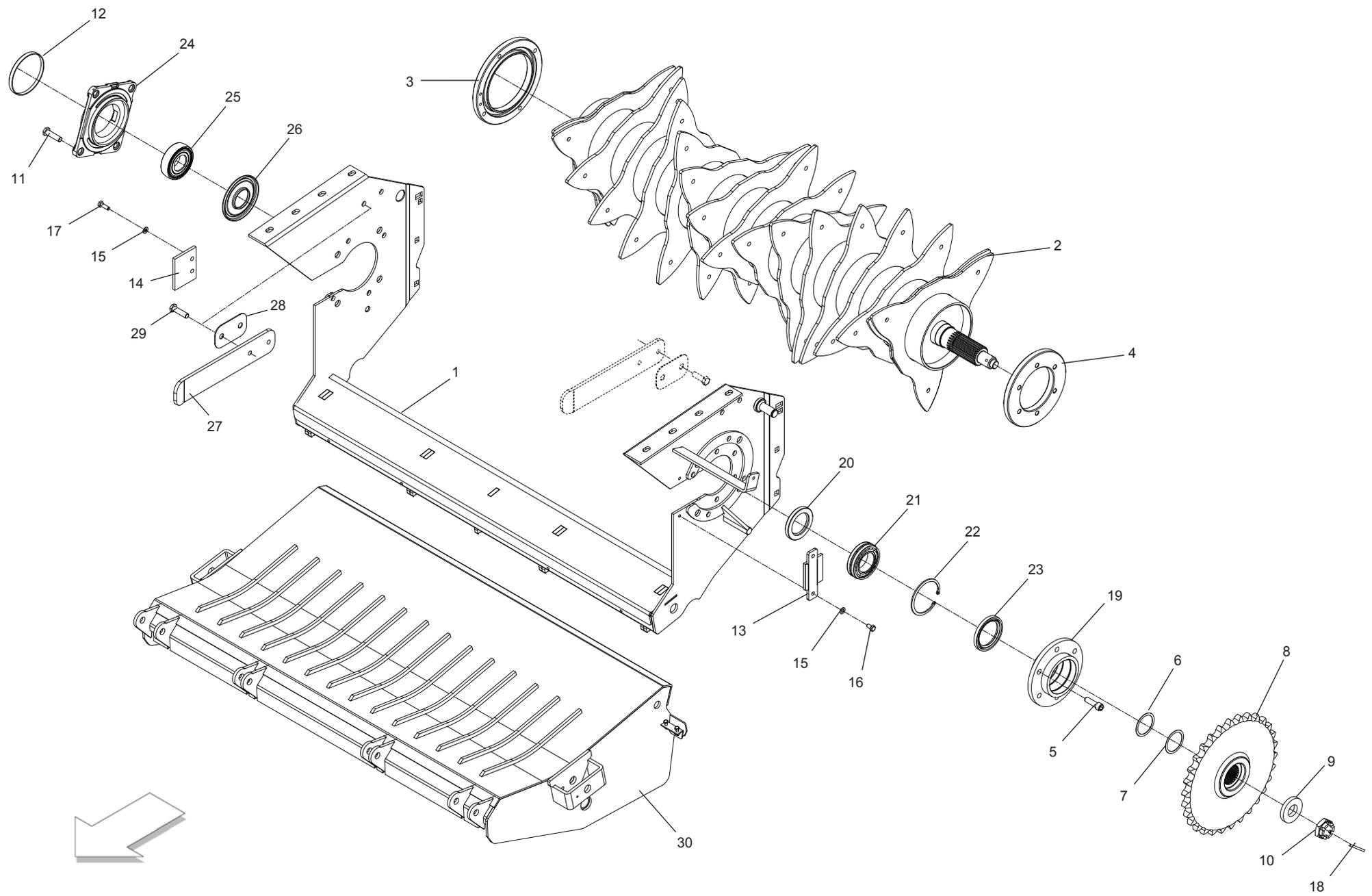
**ROTOR: TELAIO + ROTORE**
