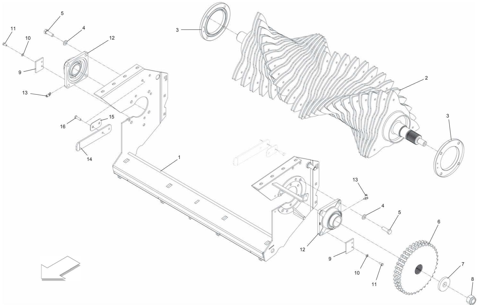
**CUT 25: TELAIO + ROTORE**
