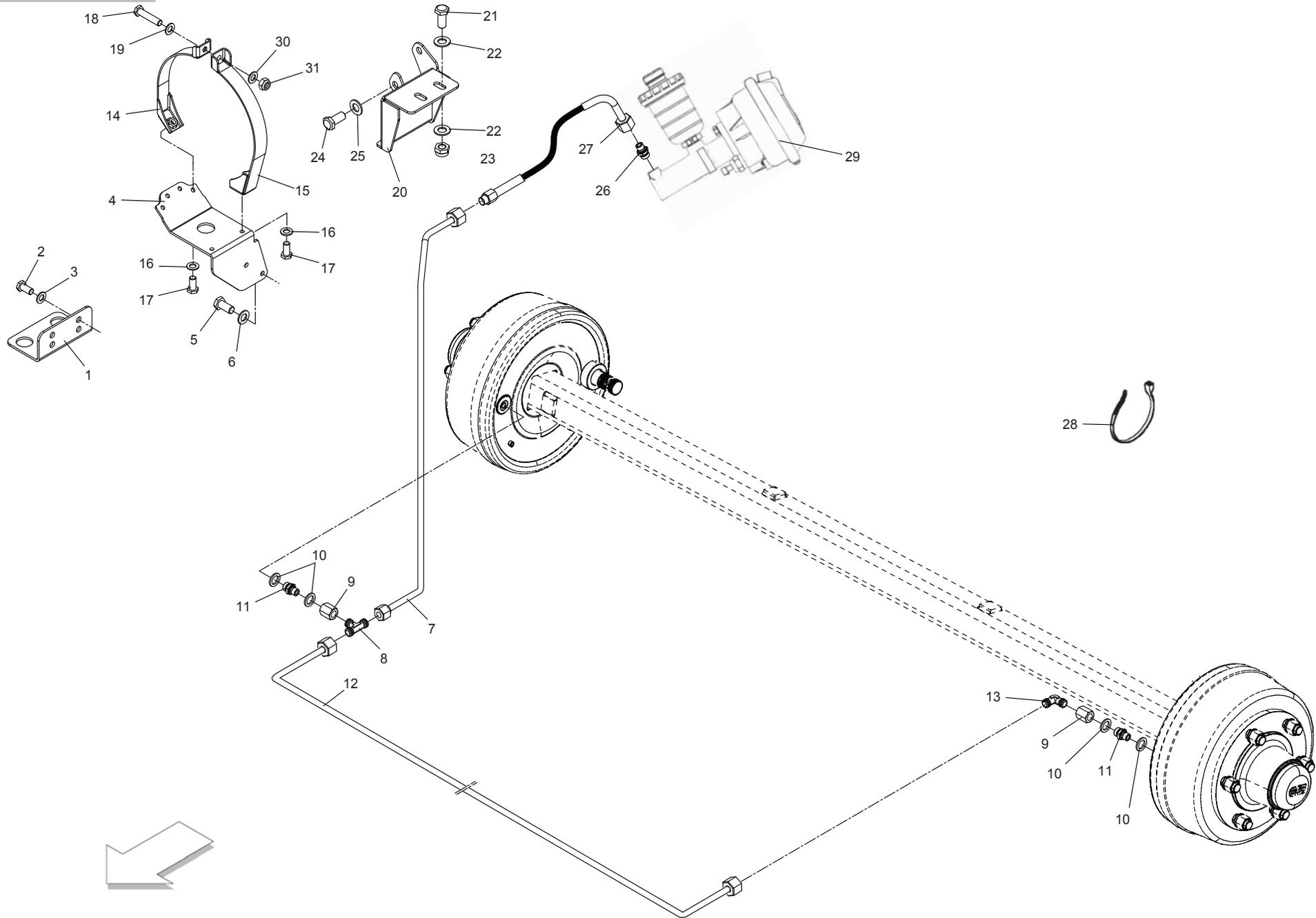
**FRENO PNEUMO-IDRAULICO (PARTE 1)**
