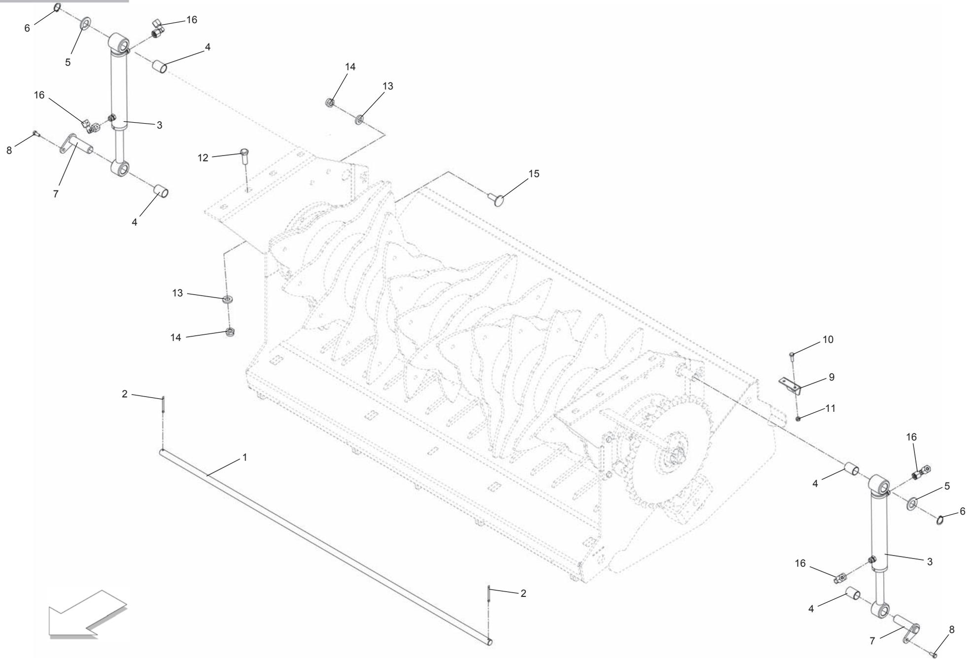
**ROTOR: MARTINETTO FONDO + VITI UNIONE TELAIO**
