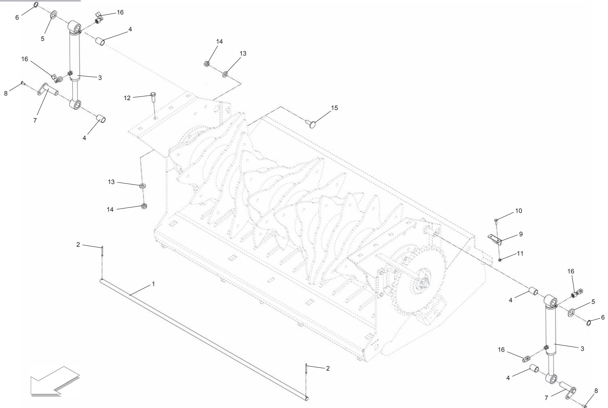
**ROTOR: MARTINETTO FONDO + VITI UNIONE TELAIO**
