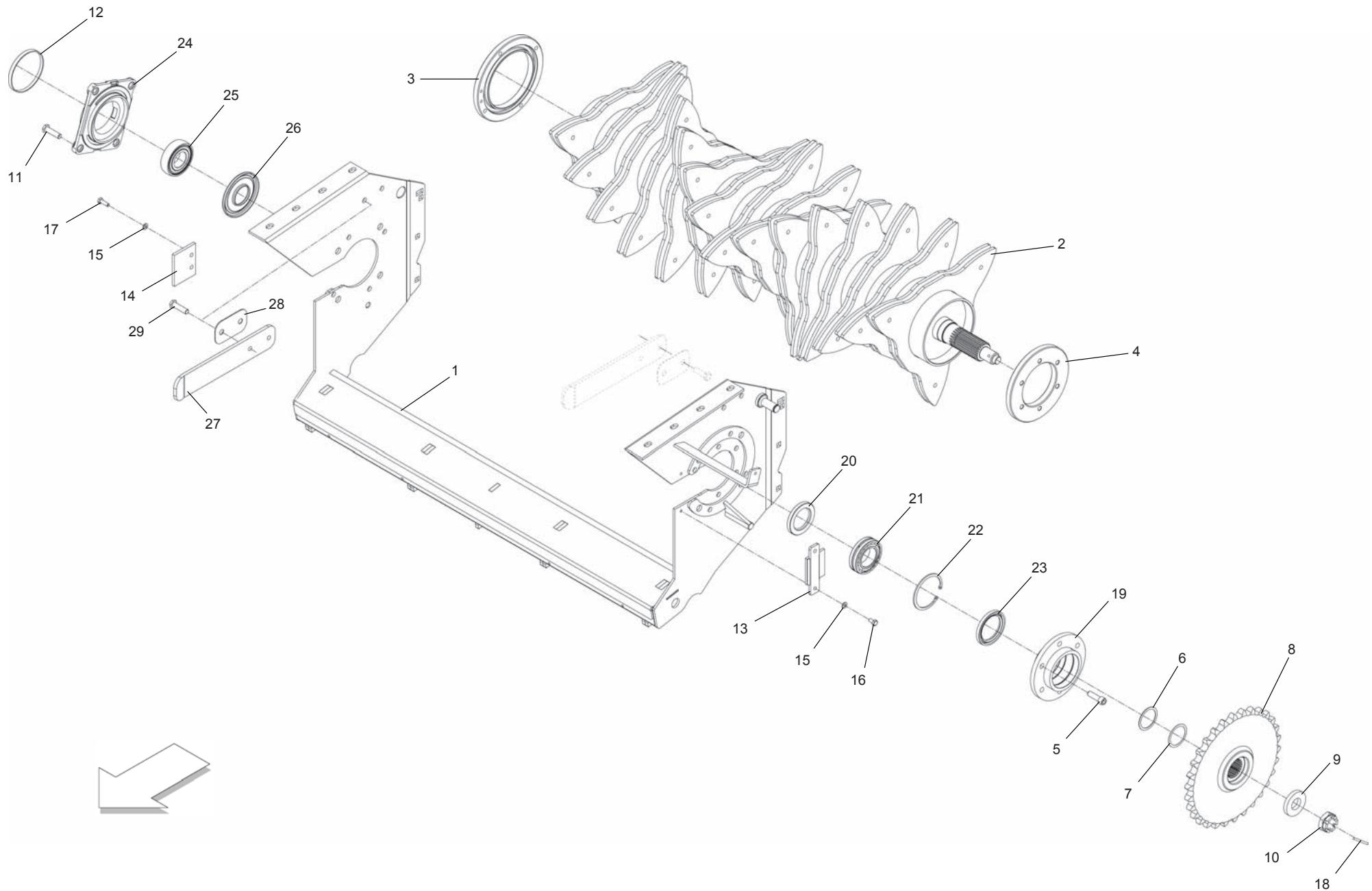
**CUT 15: TELAIO + ROTORE
