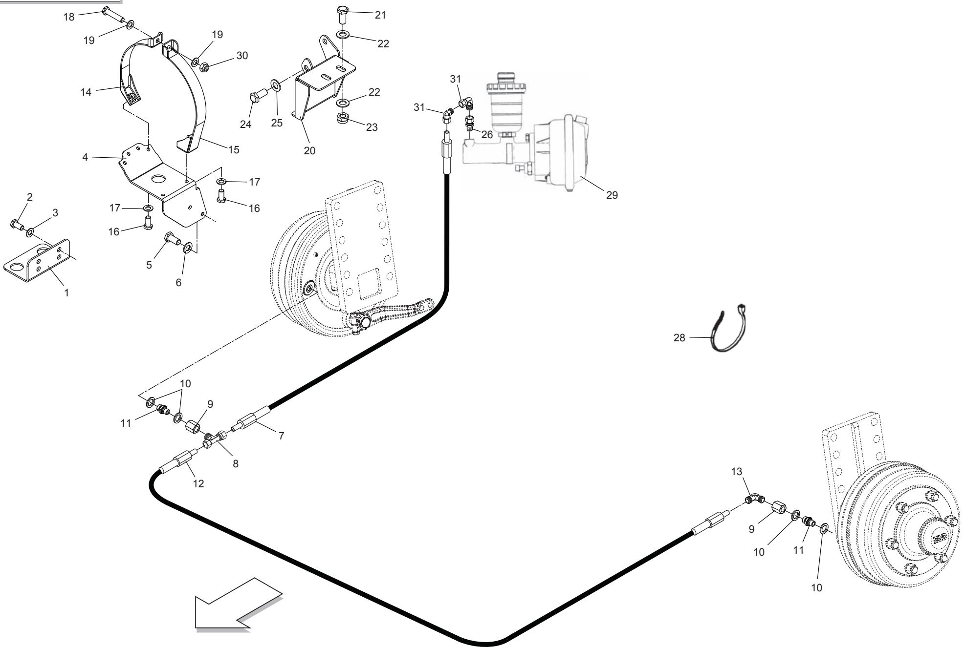
**FRENO PNEUMO-IDRAULICO (PARTE 1)**
