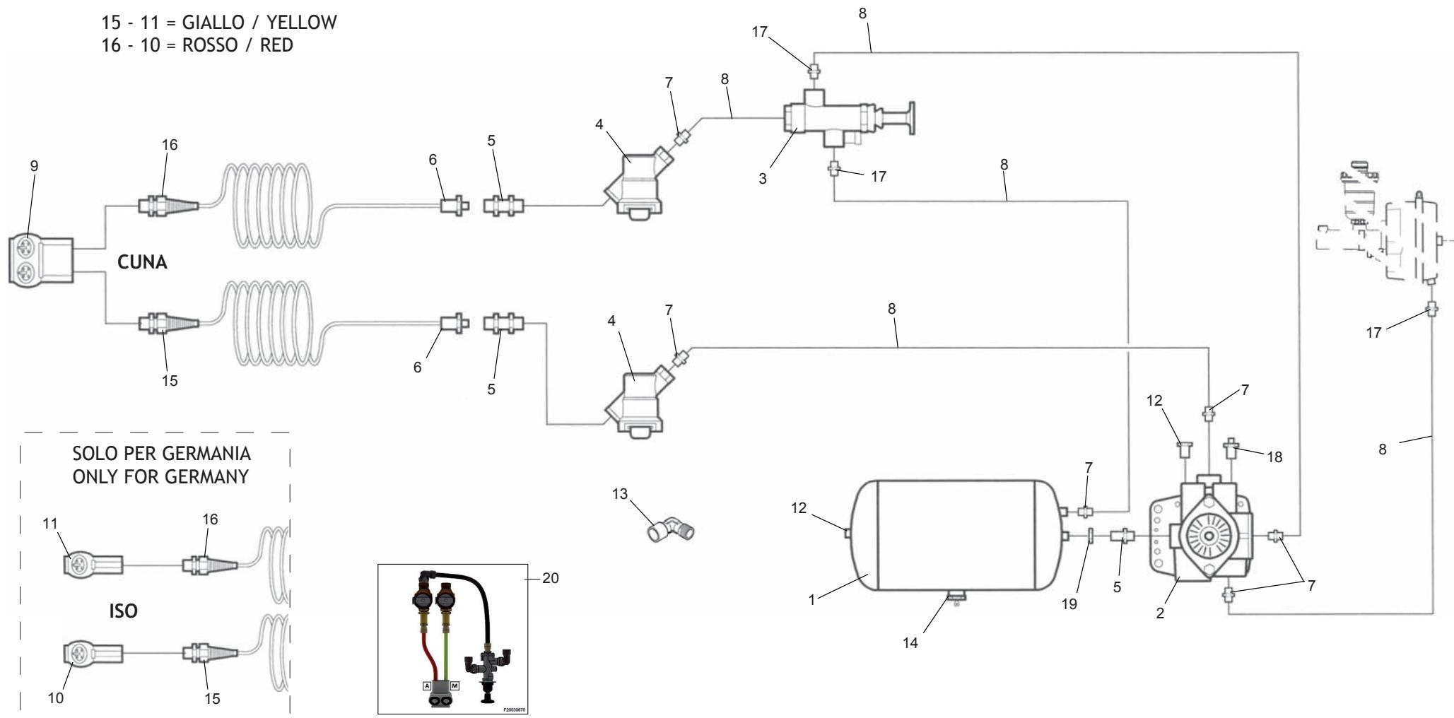
**FRENO PNEUMO-IDRAULICO (PARTE 2)**
