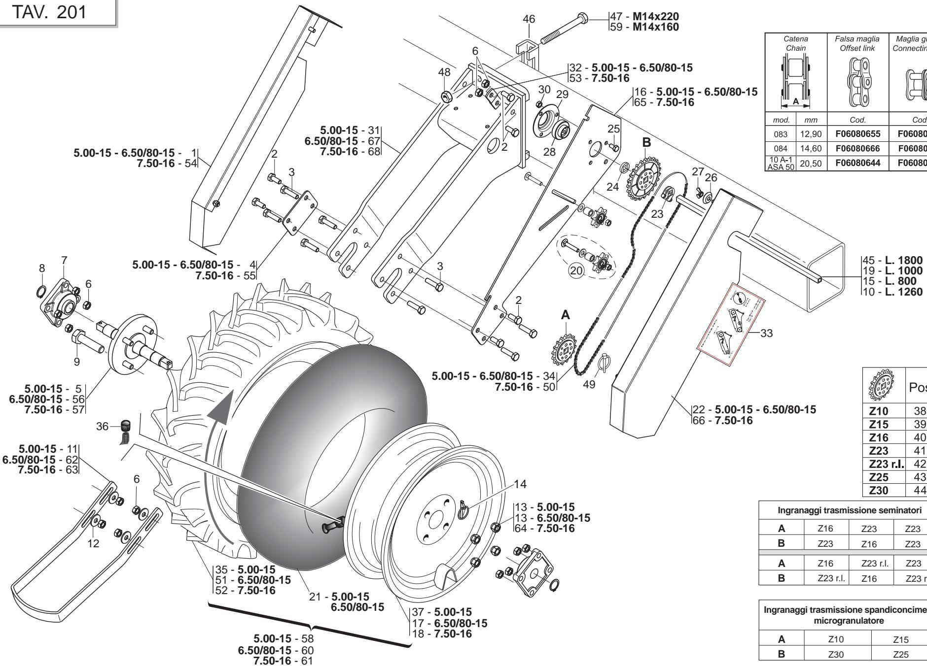
**RUOTE DI TRASMISSIONE**
