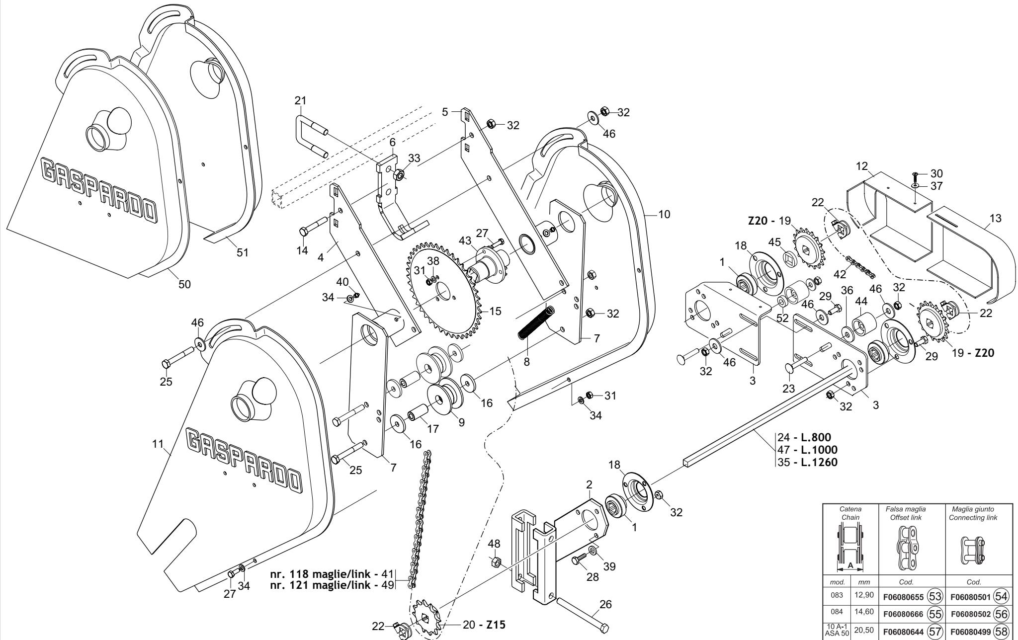
**TRASMISSIONE SPANDICONCIME E MICROGRANULATORE**
