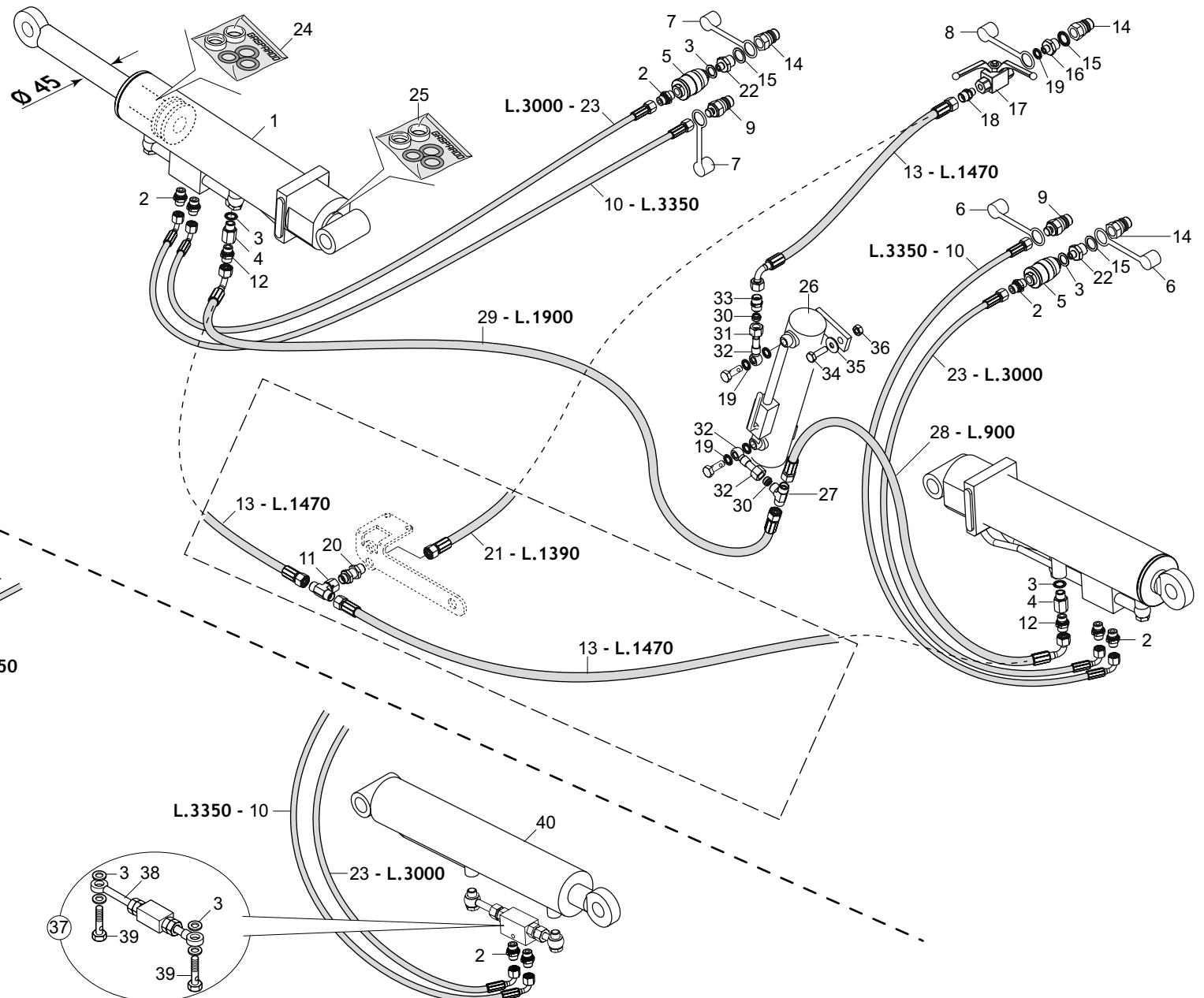
**IMPIANTO OLEODINAMICO TELAIO «DIN 24»**
