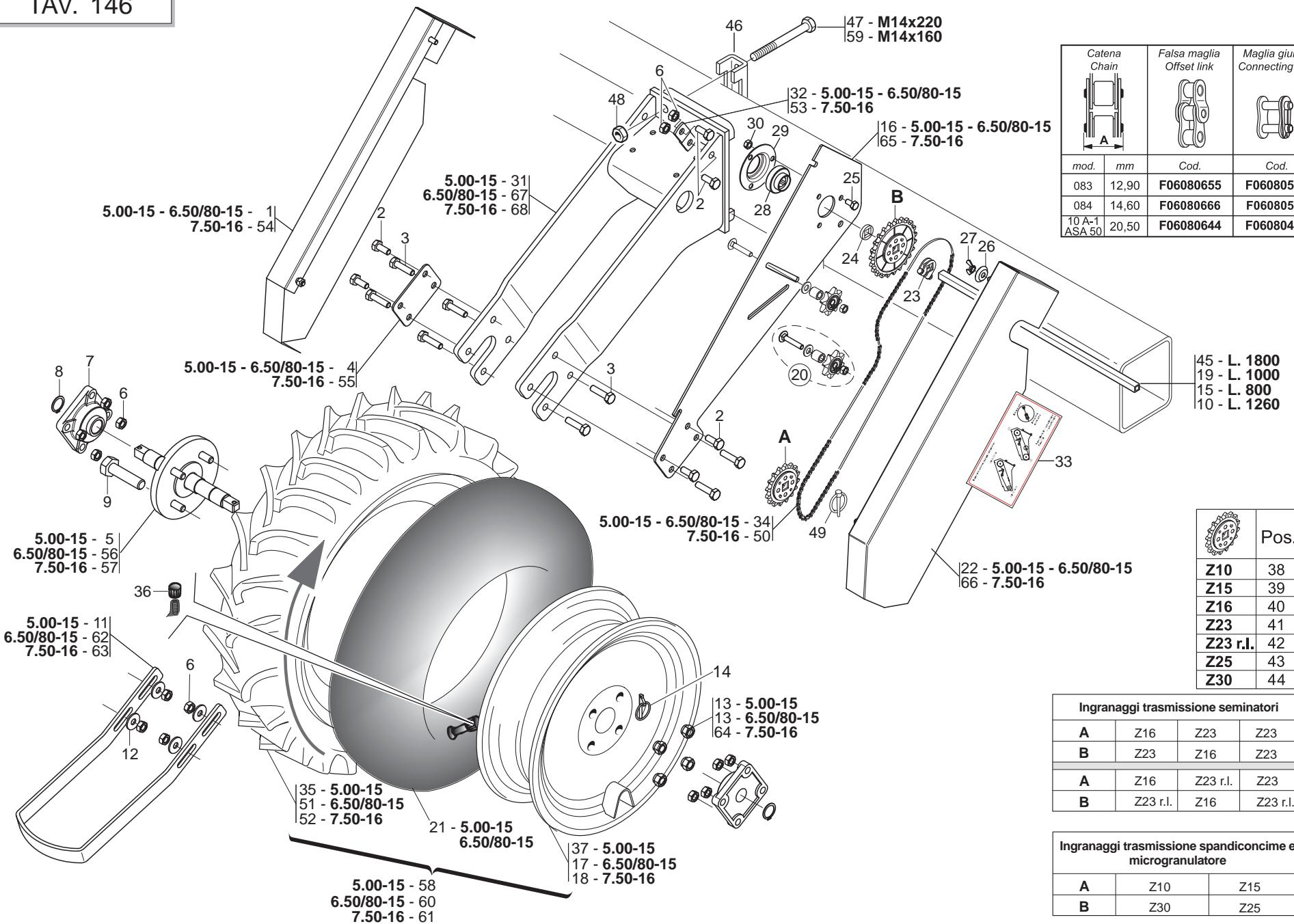
**RUOTE DI TRASMISSIONE**
