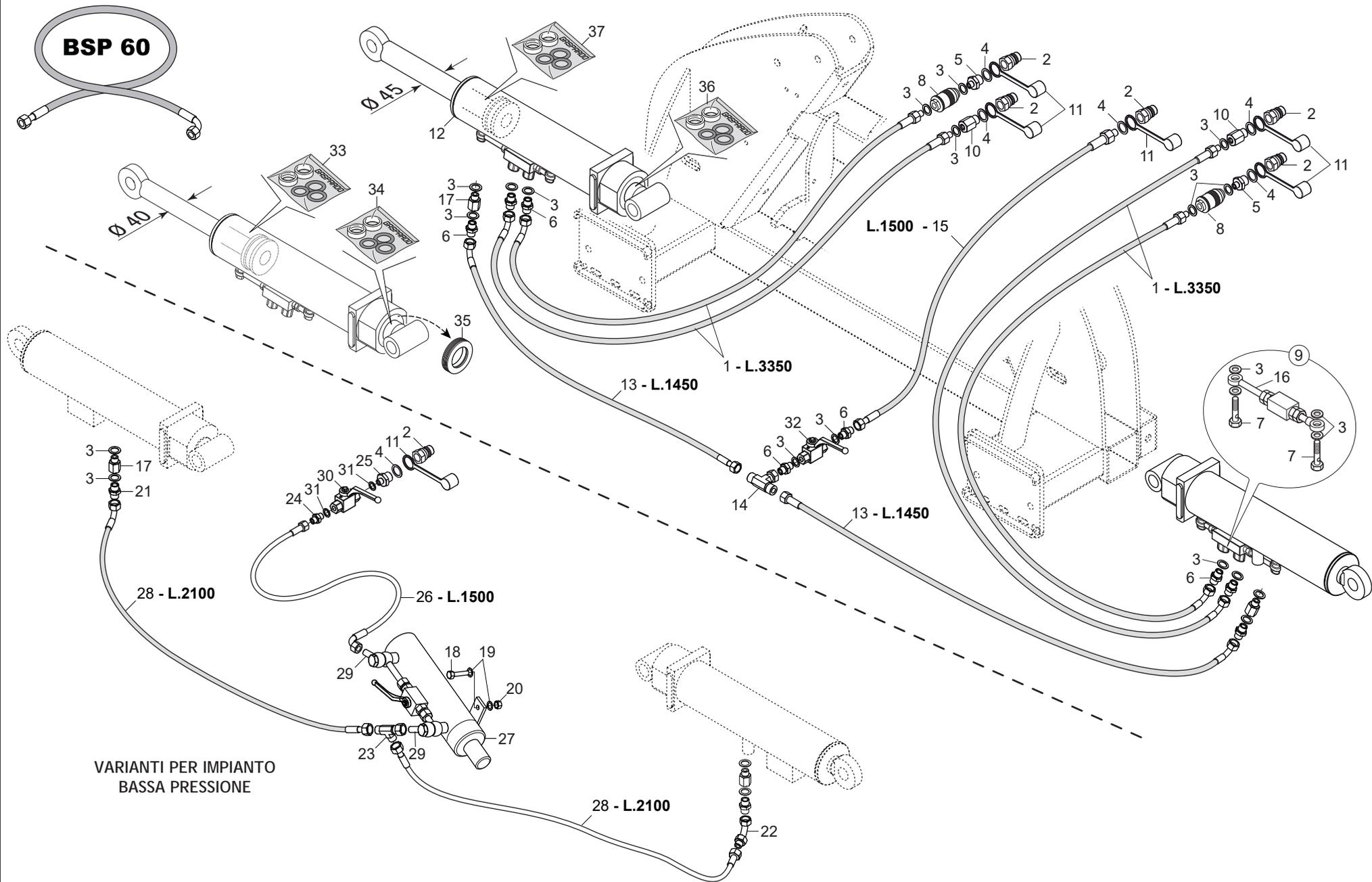
**IMPIANTO OLEODINAMICO TELAIO «BSP 60»**
