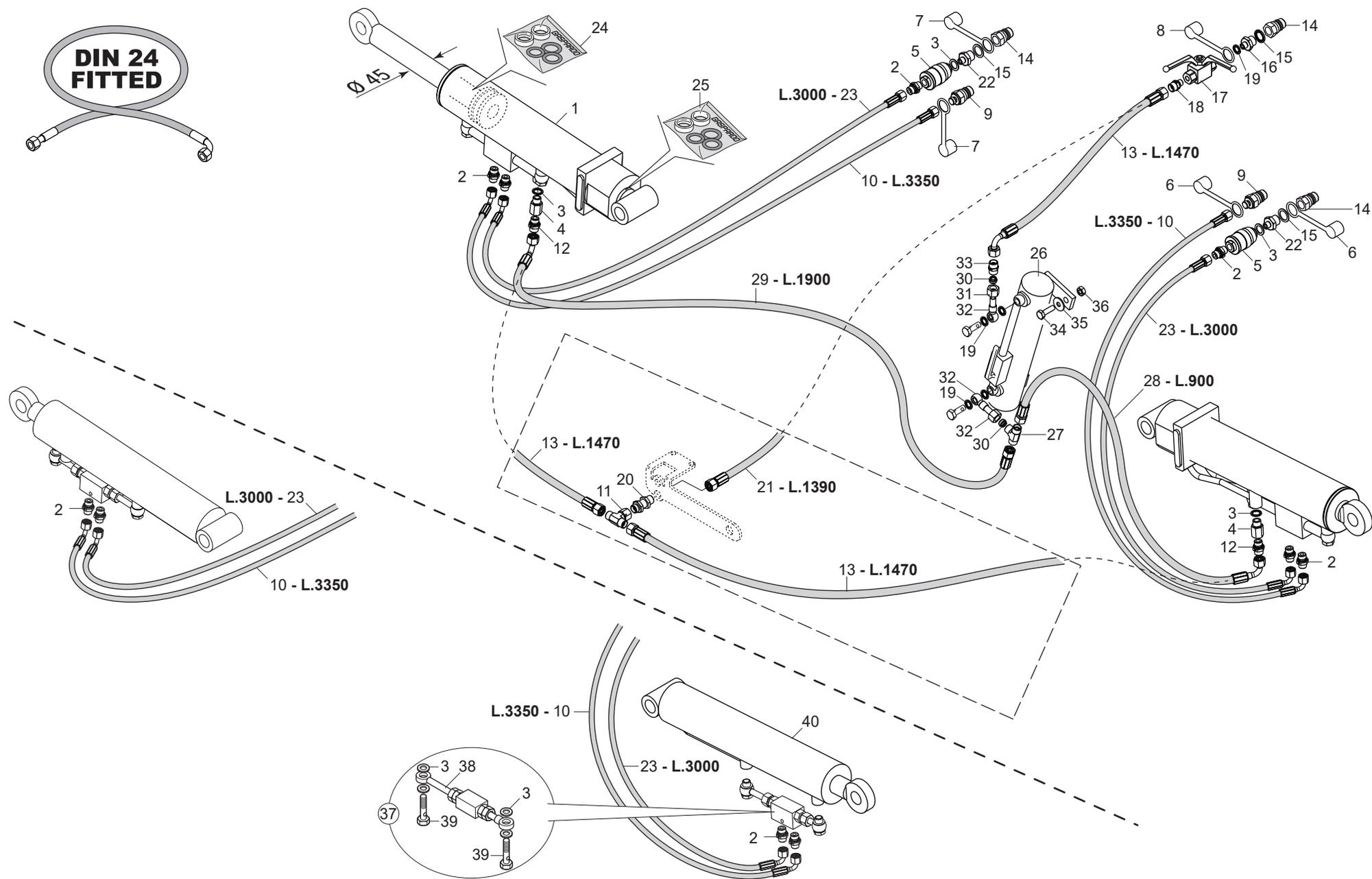
**IMPIANTO OLEODINAMICO TELAIO «DIN 24»**
