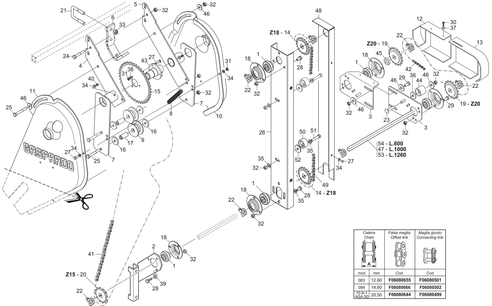
**TRASMISSIONE SPANDICONCIME E MICROGRANULATORE NELLA VERSIONE «DEXON»**
