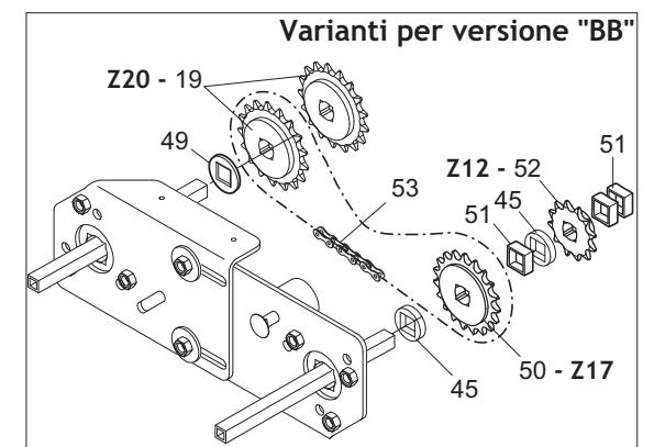
**TRASMISSIONE SPANDICONCIME E MICROGRANULATORE**
