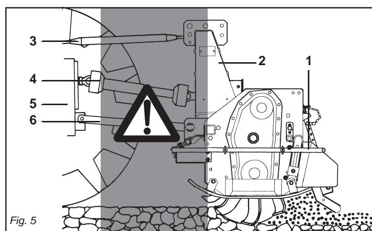
1) Protezione laterale. - 2) Castello di sostegno attacco 3 punti. - 3) Tirante di regolazione inclinazione.
