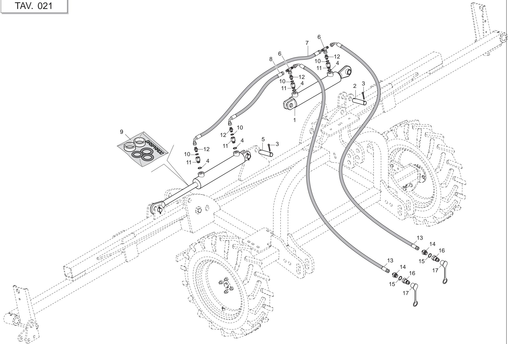
**IMPIANTO OLEODINAMICO TELAIO**
