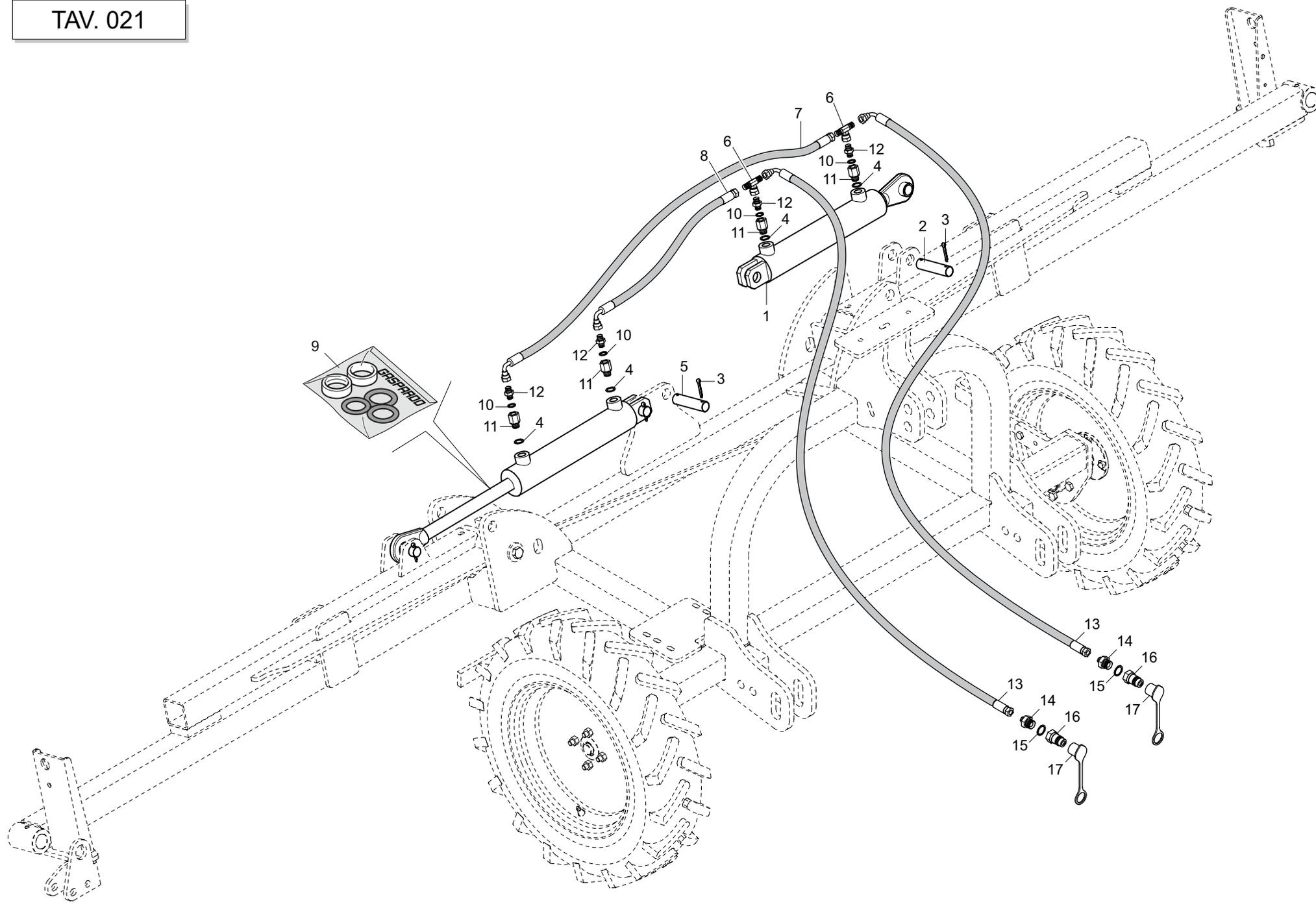
**IMPIANTO OLEODINAMICO TELAIO
