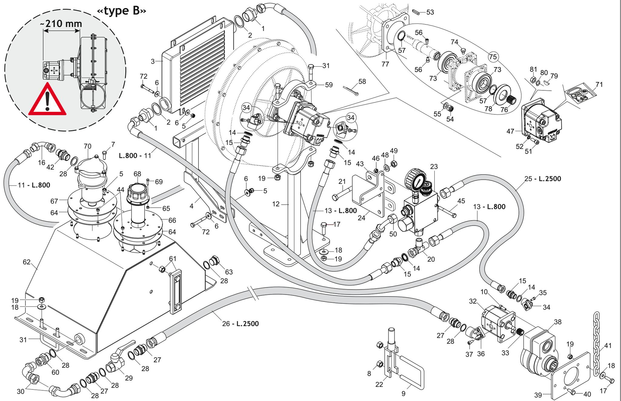
**SOFFIANTE AD AZIONAMENTO OLEODINAMICO INDIPENDENTE «TIPO B»
