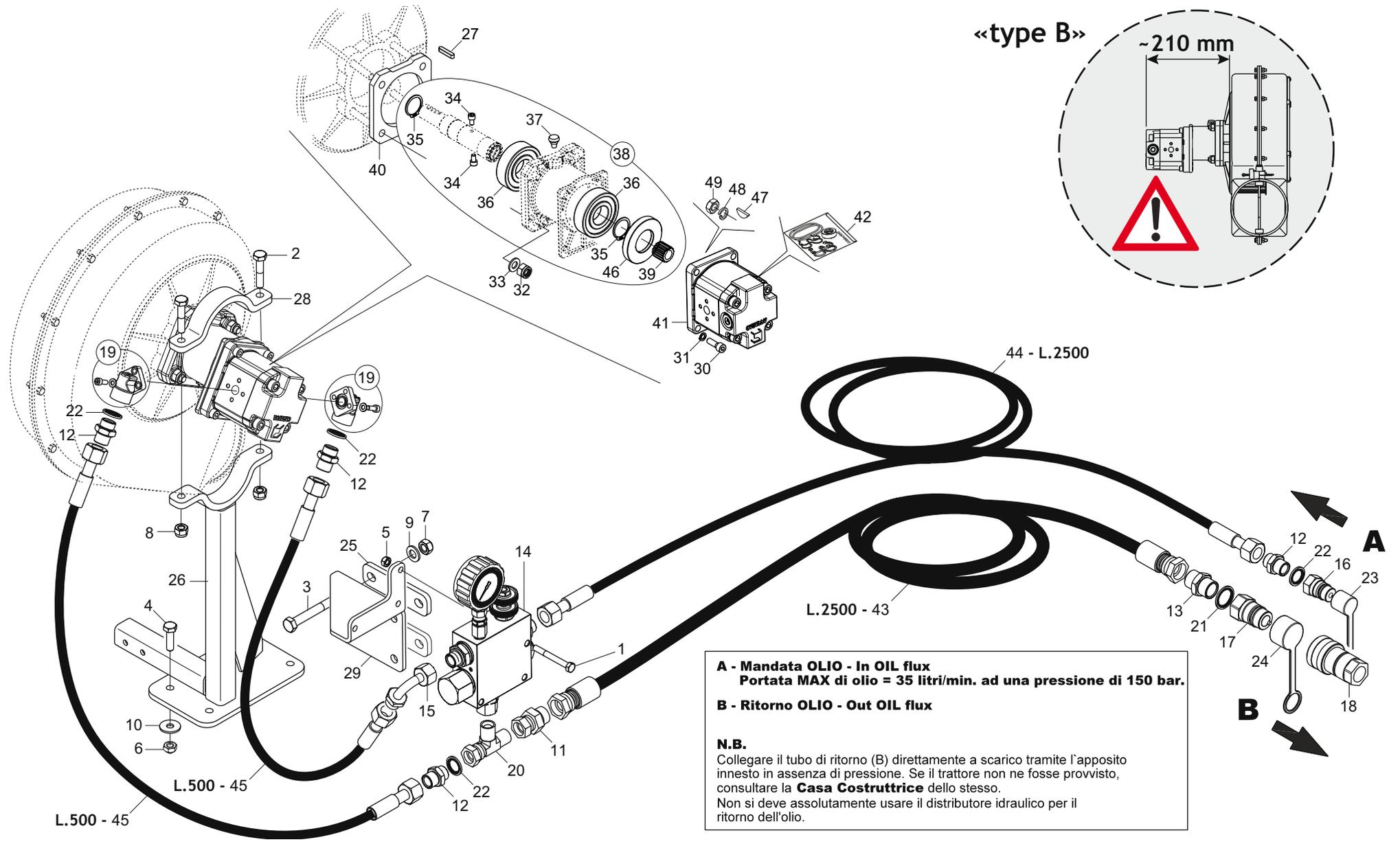
**SOFFIANTE AD AZIONAMENTO OLEODINAMICO DIPENDENTE «TIPO B»
