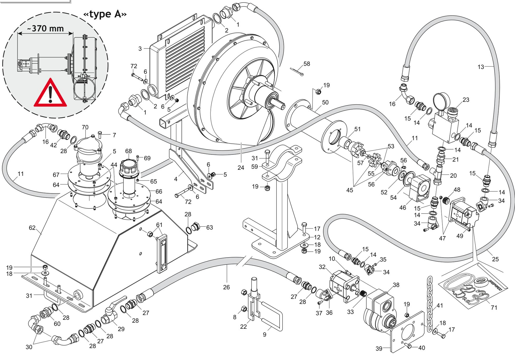
**SOFFIANTE AD AZIONAMENTO OLEODINAMICO INDIPENDENTE «TIPO A»
