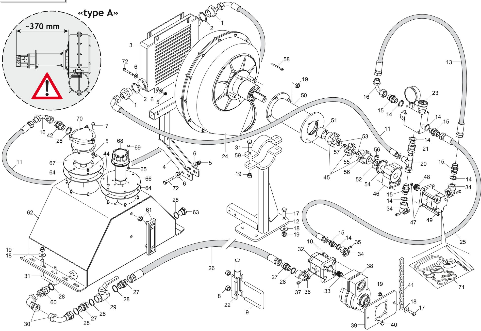
**SOFFIANTE AD AZIONAMENTO OLEODINAMICO INDIPENDENTE «TIPO A»
