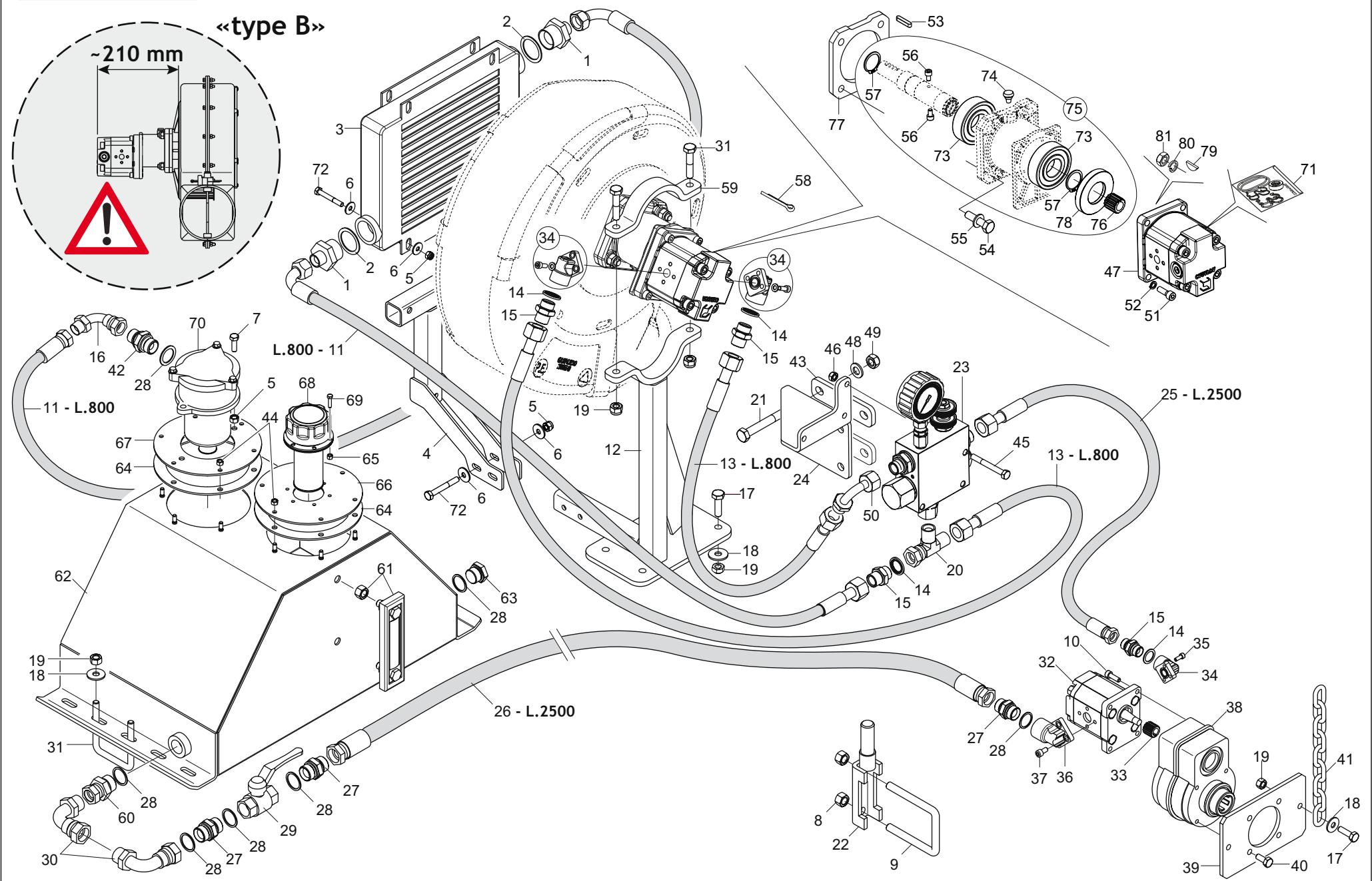
**SOFFIANTE AD AZIONAMENTO OLEODINAMICO INDIPENDENTE «TIPO B»**
