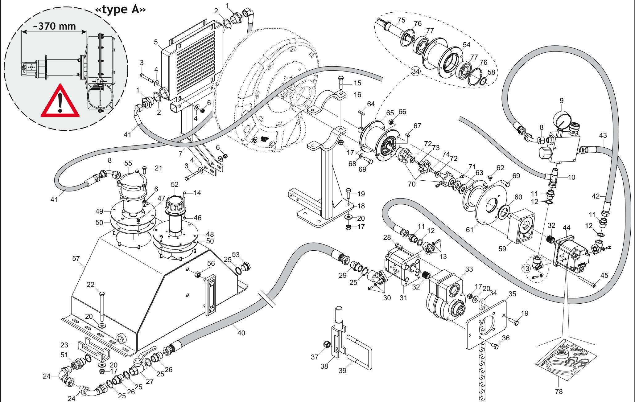
**SOFFIANTE AD AZIONAMENTO OLEODINAMICO INDIPENDENTE «TIPO A»**
