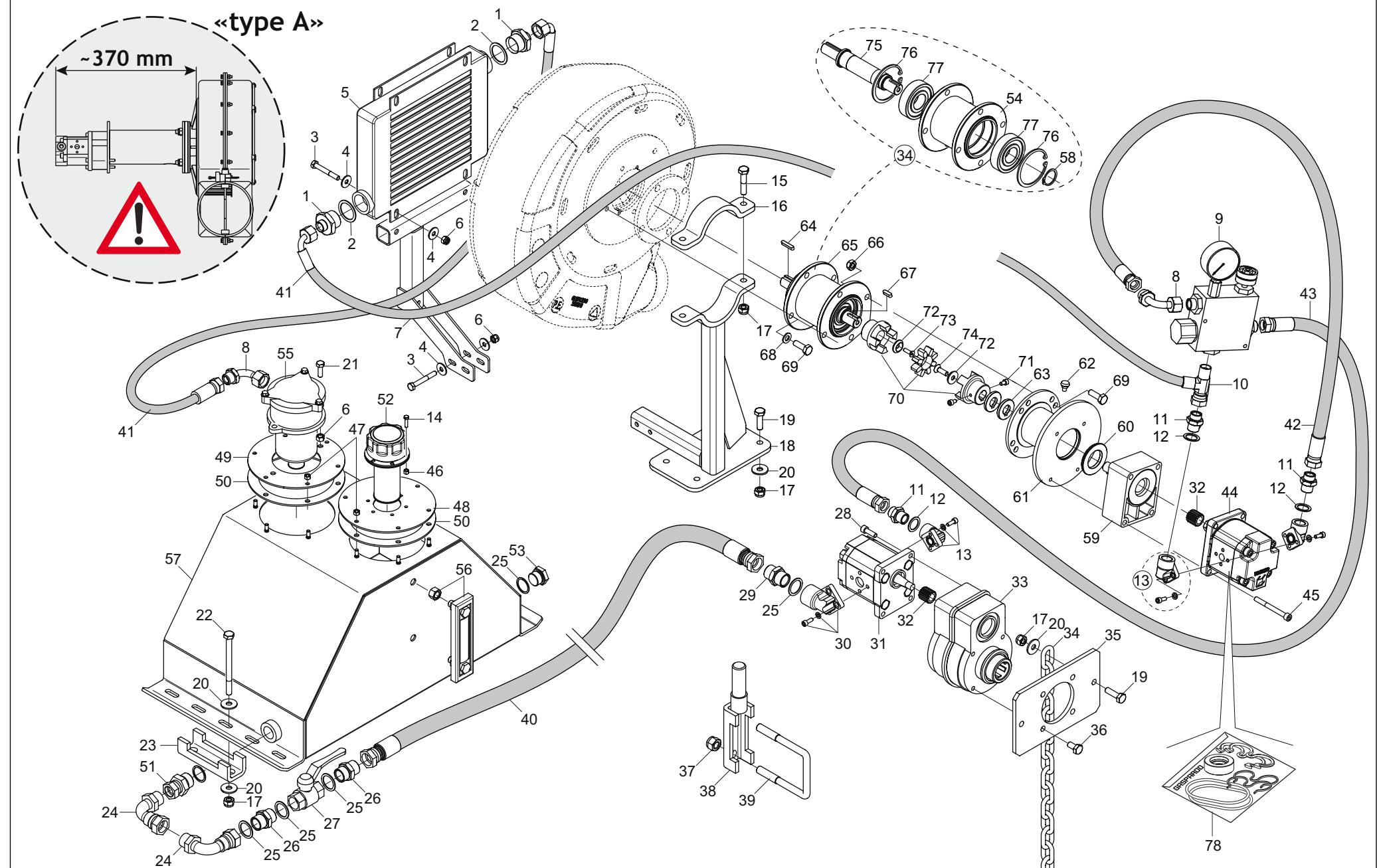
**SOFFIANTE AD AZIONAMENTO OLEODINAMICO INDIPENDENTE «TIPO A»**
