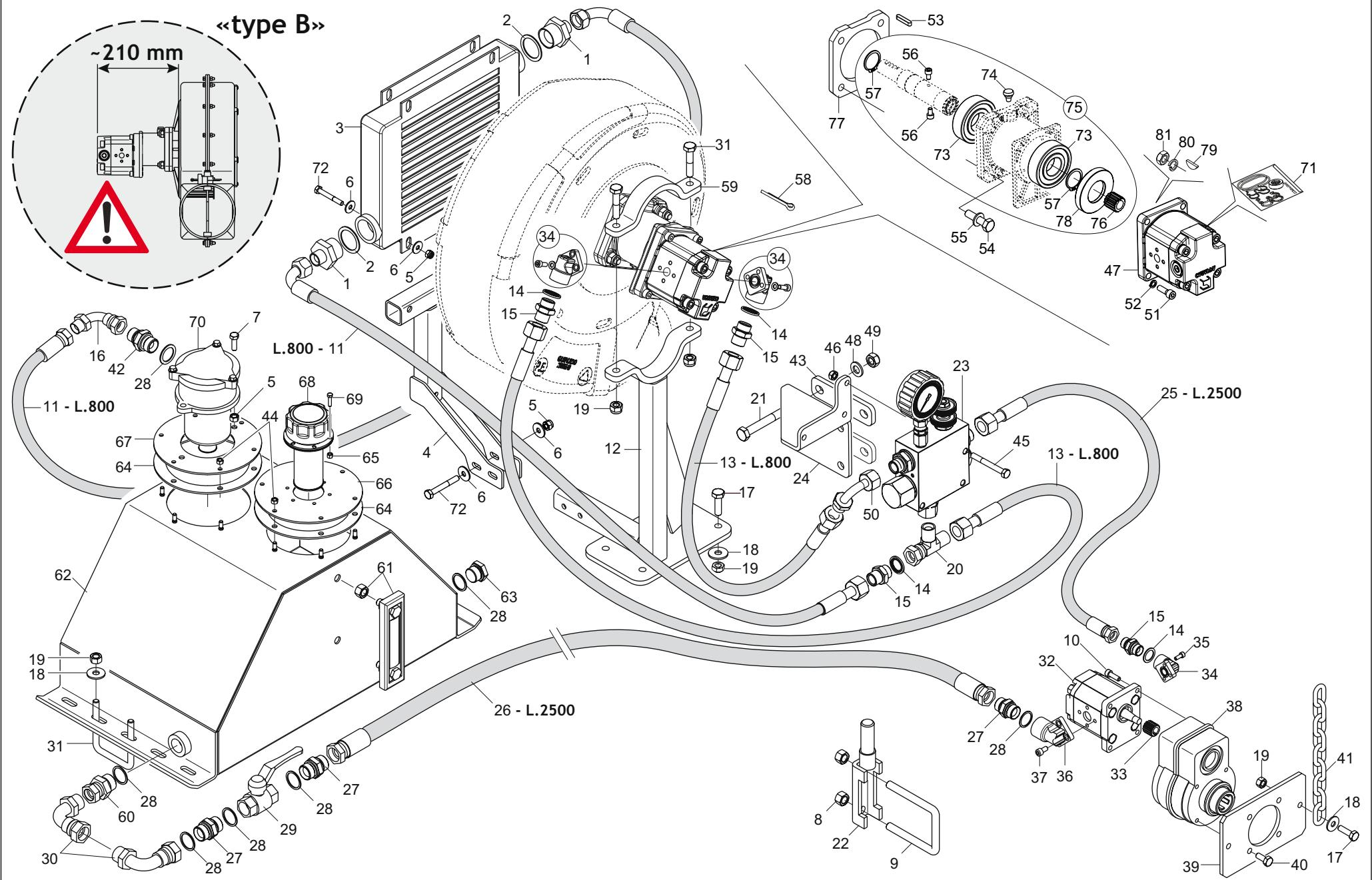
**SOFFIANTE AD AZIONAMENTO OLEODINAMICO INDIPENDENTE «TIPO B»**
