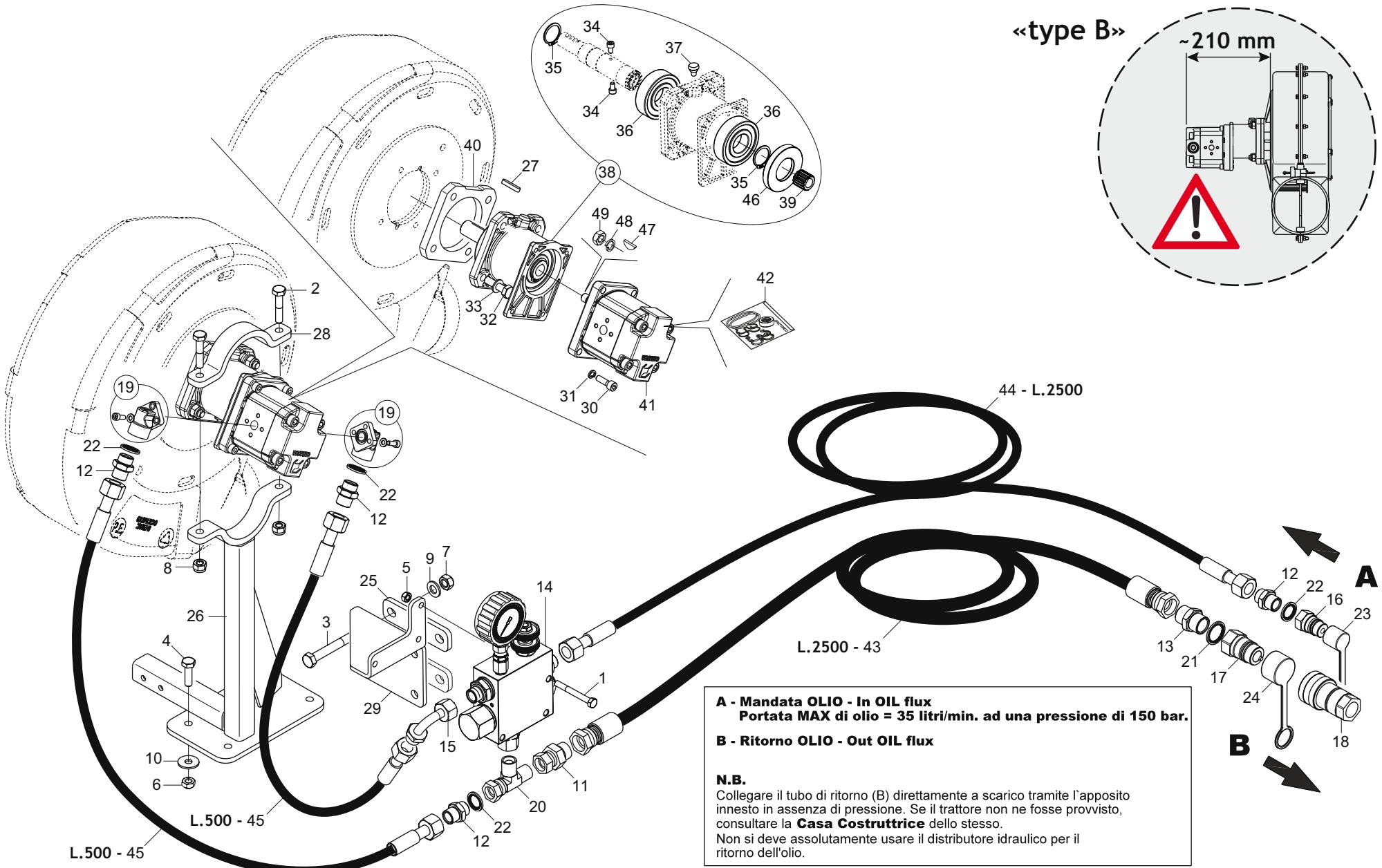
**SOFFIANTE AD AZIONAMENTO OLEODINAMICO DIPENDENTE «TIPO B»**
