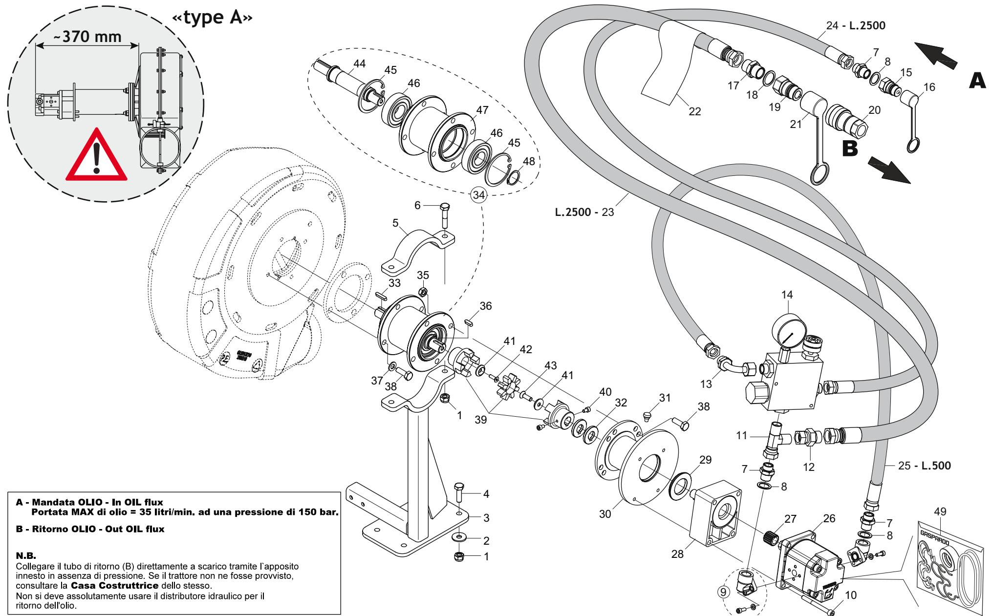
**SOFFIANTE AD AZIONAMENTO OLEODINAMICO DIPENDENTE «TIPO A»**
