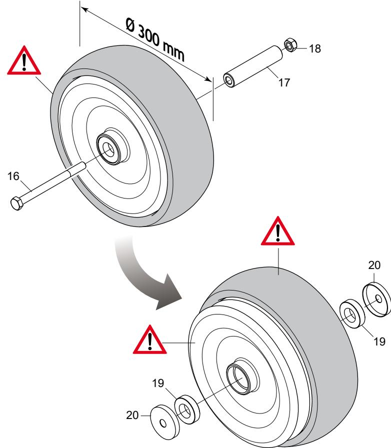
Sostituito da Ruota Completa Ø 250 mm (cod. G13643260)
