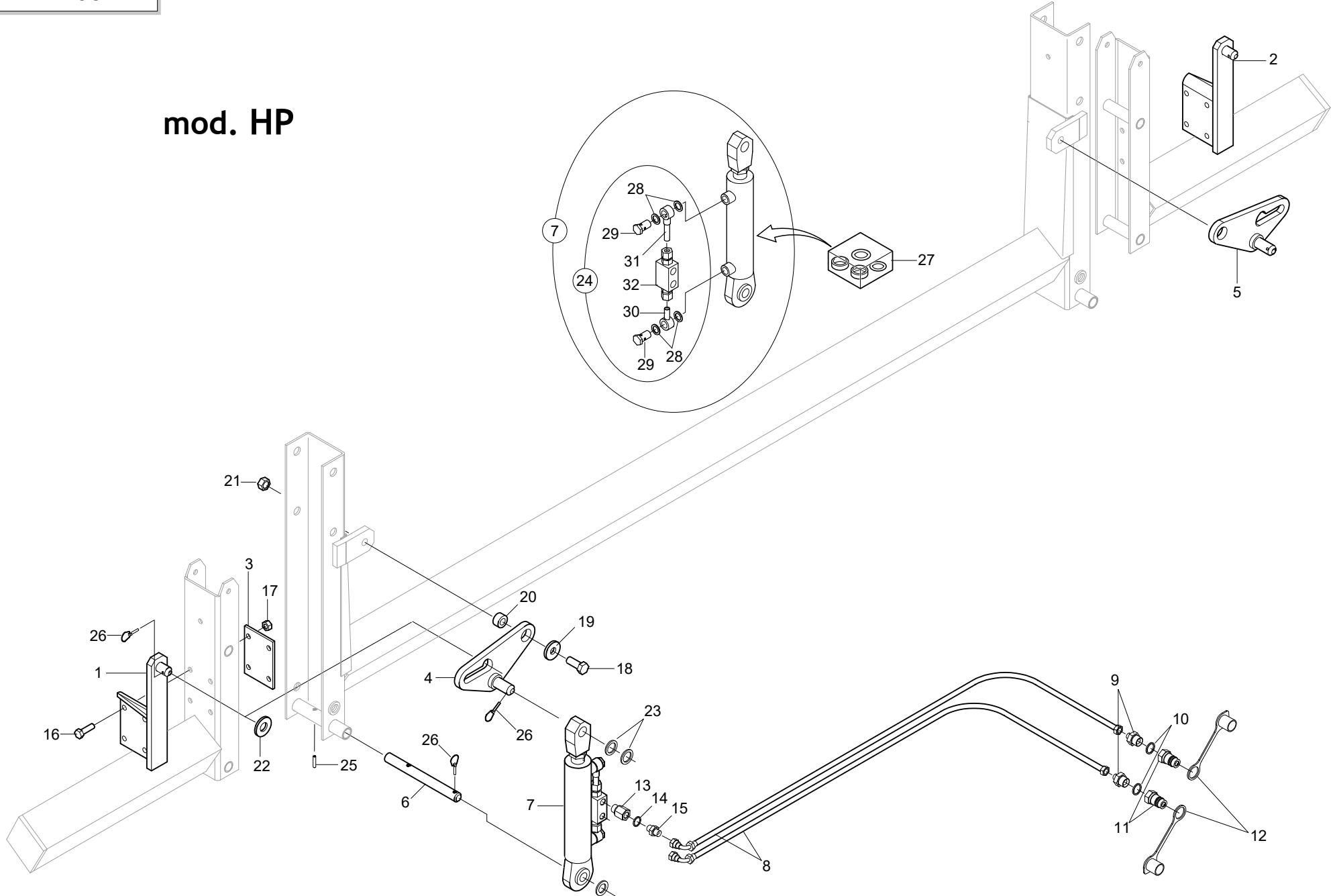
**IMPIANTO OLEODINAMICO TELAIO «HP»**
