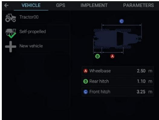
Arag Isobus software è l'evoluzione di Arag Navigation software da cui ne eredita l'affidabilità e la semplicità d'uso. La funzionalità di configurazione permette di memorizzare infinite combinazioni di trattori-atrezzi, anche semoventi, e di richiamarli all'occorrenza. Ad ogni accensione il sistema verificherà che tutte le unità di controllo ISOBUS siano presenti e funzionanti, sgravando l'operatore da questo compito.
