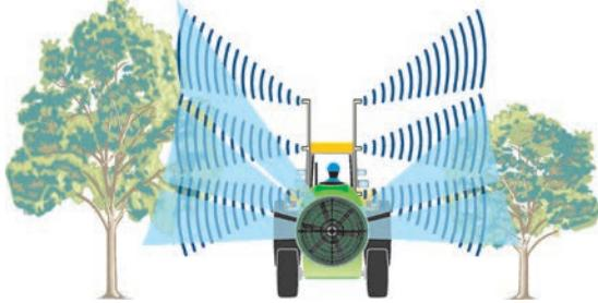
3 - Altezza piante: Irrorazione della chioma della pianta tramite il frazionamento delle raggiere.
