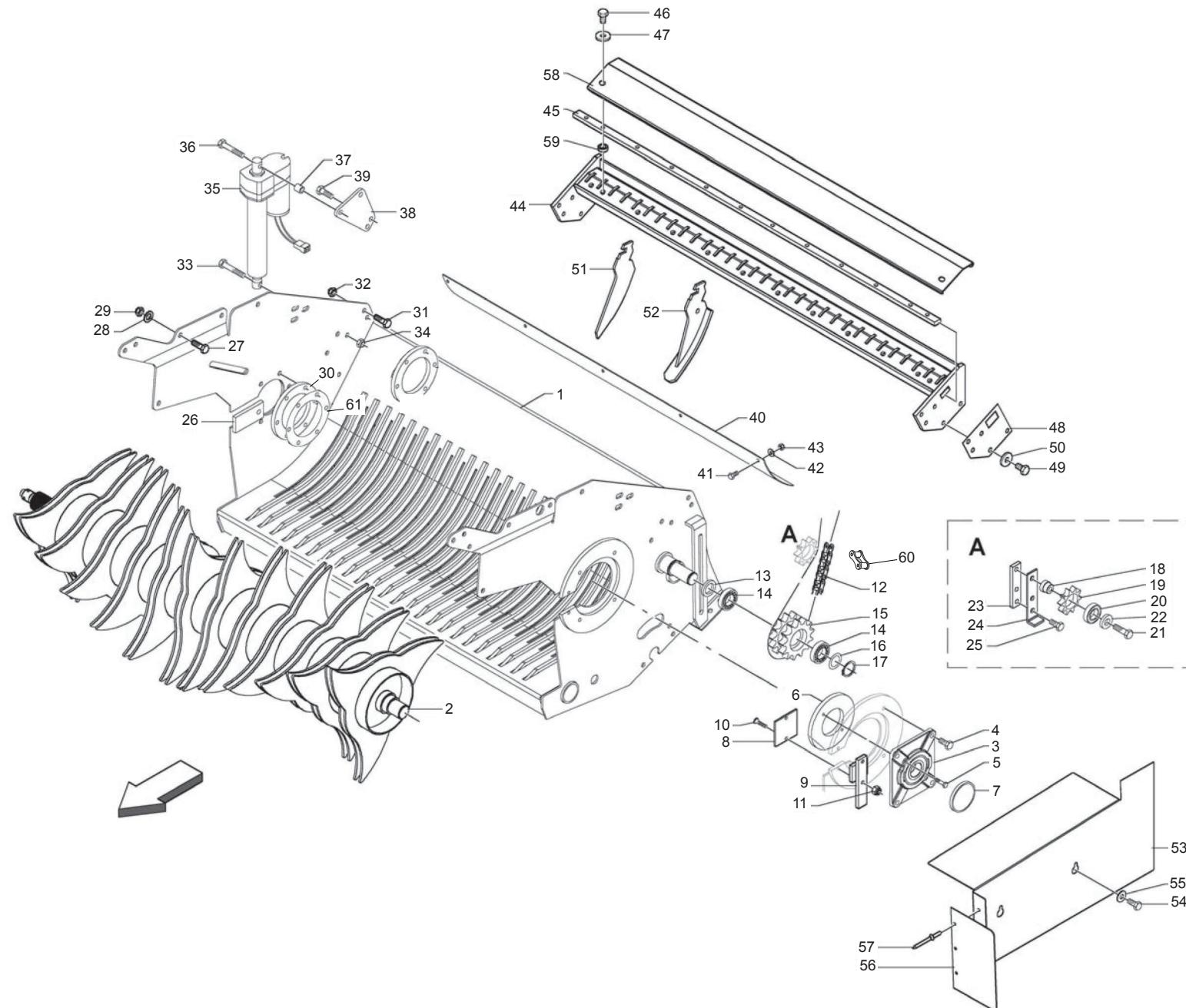
**CUT 13: TELAIO + ROTORE**
