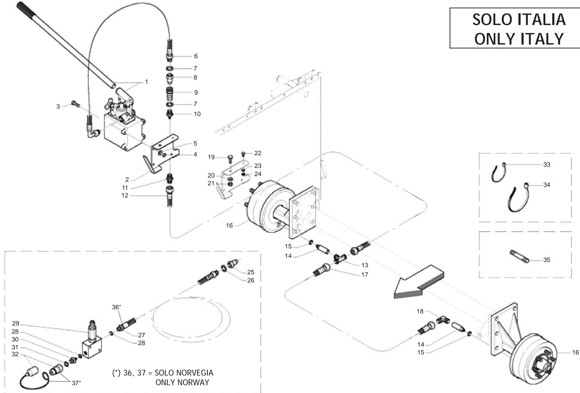
**DISPOSITIVO DI STAZIONAMENTO IDRAULICO (CUT)**
