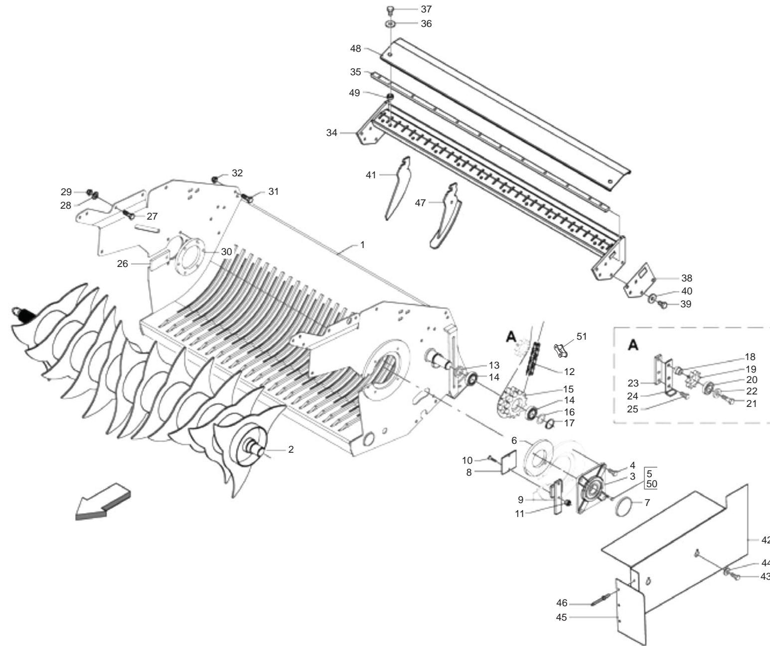
**ROTOR: TELAIO + ROTORE**
