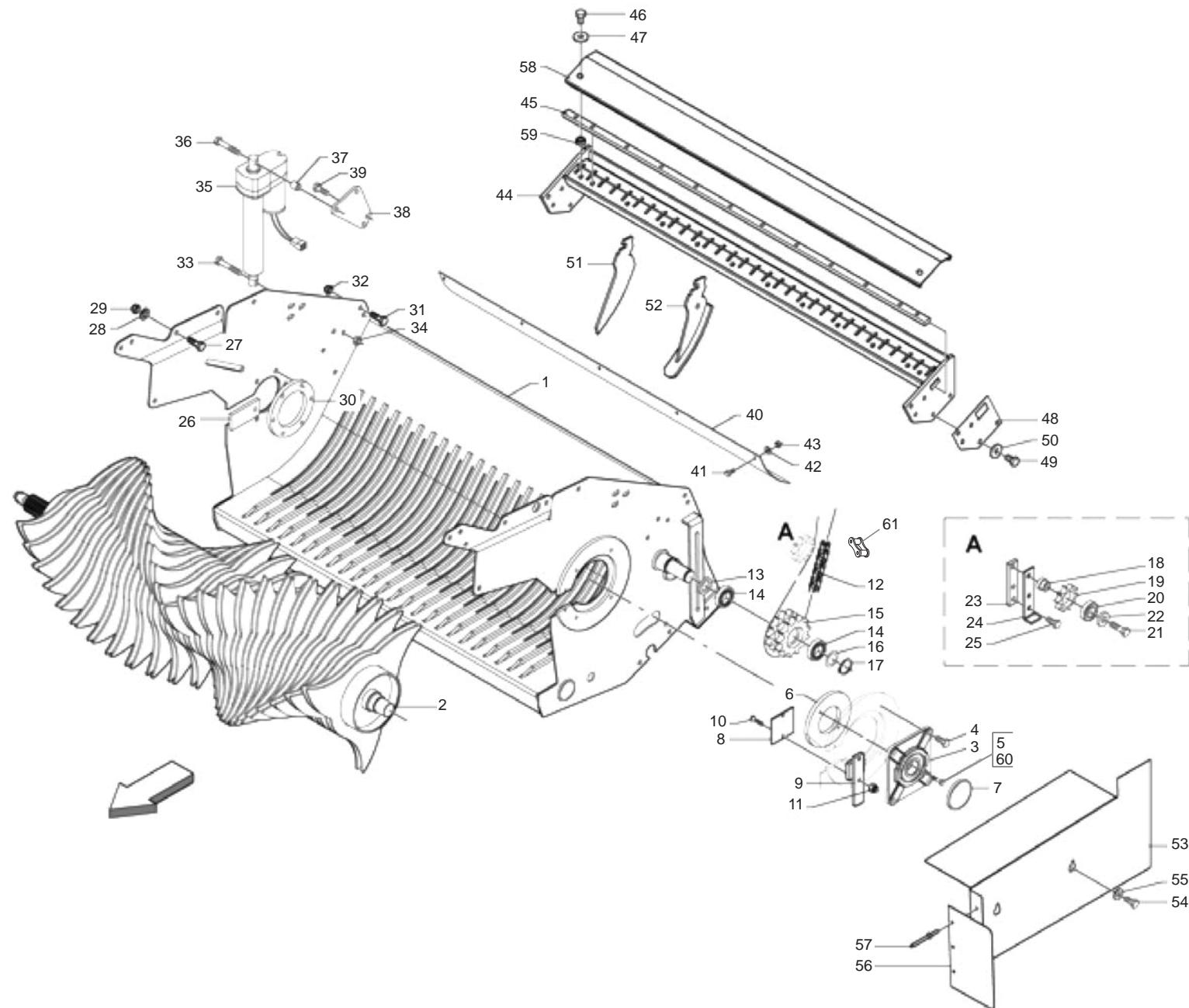
**CUT 25: TELAIO + ROTORE**
