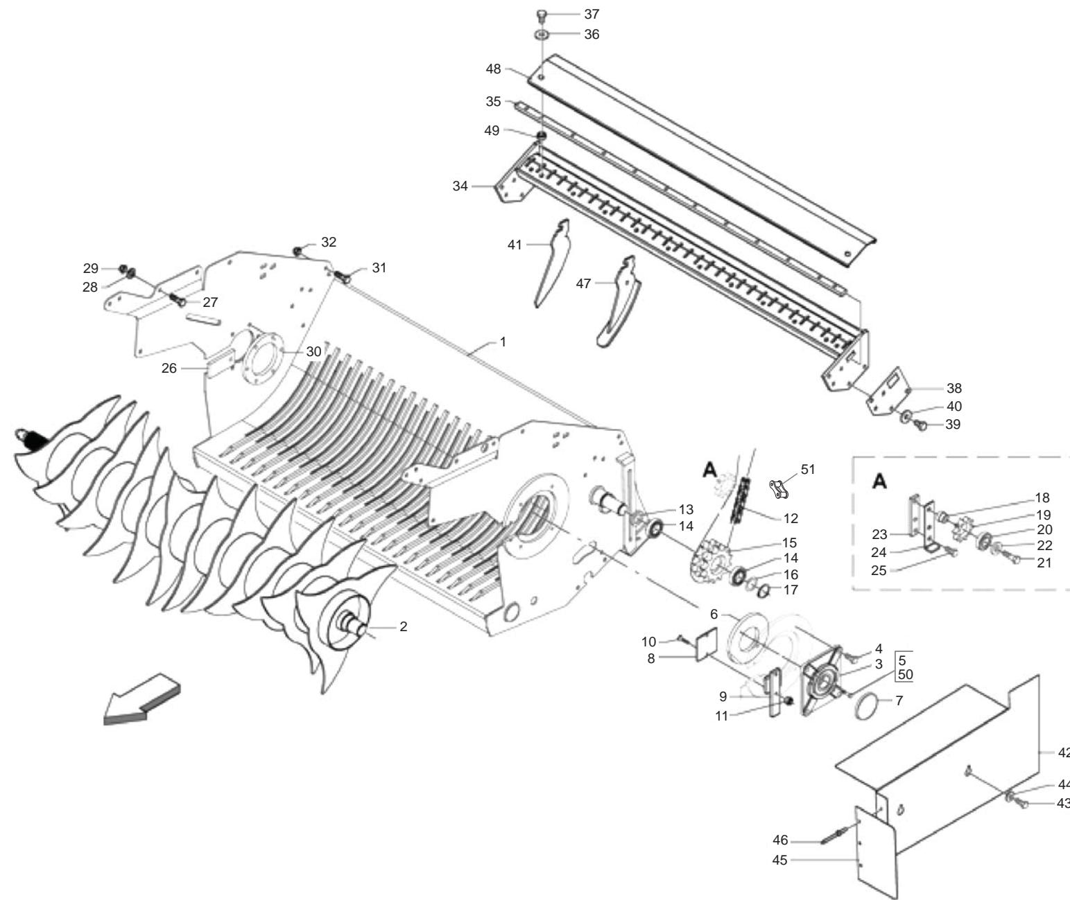
**ROTOR: TELAIO + ROTORE**
