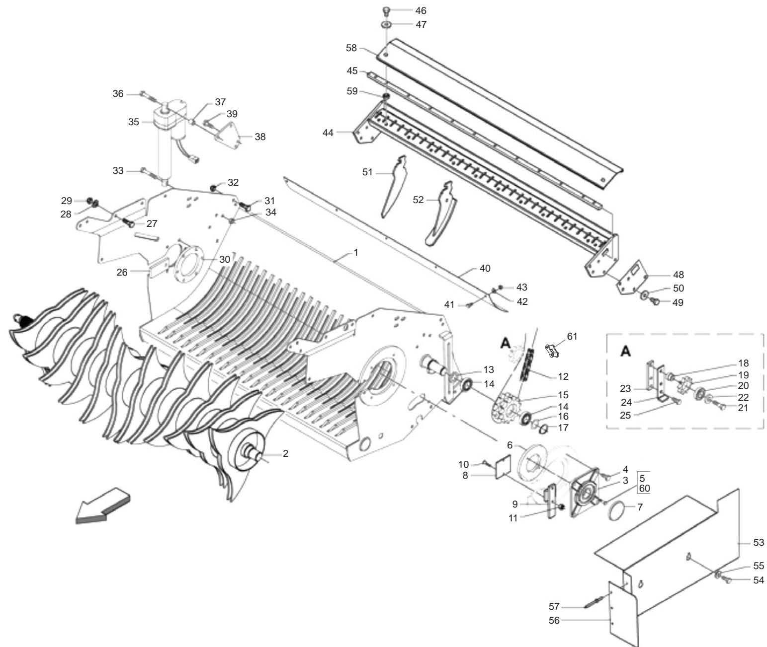
**CUT 13: TELAIO + ROTORE**
