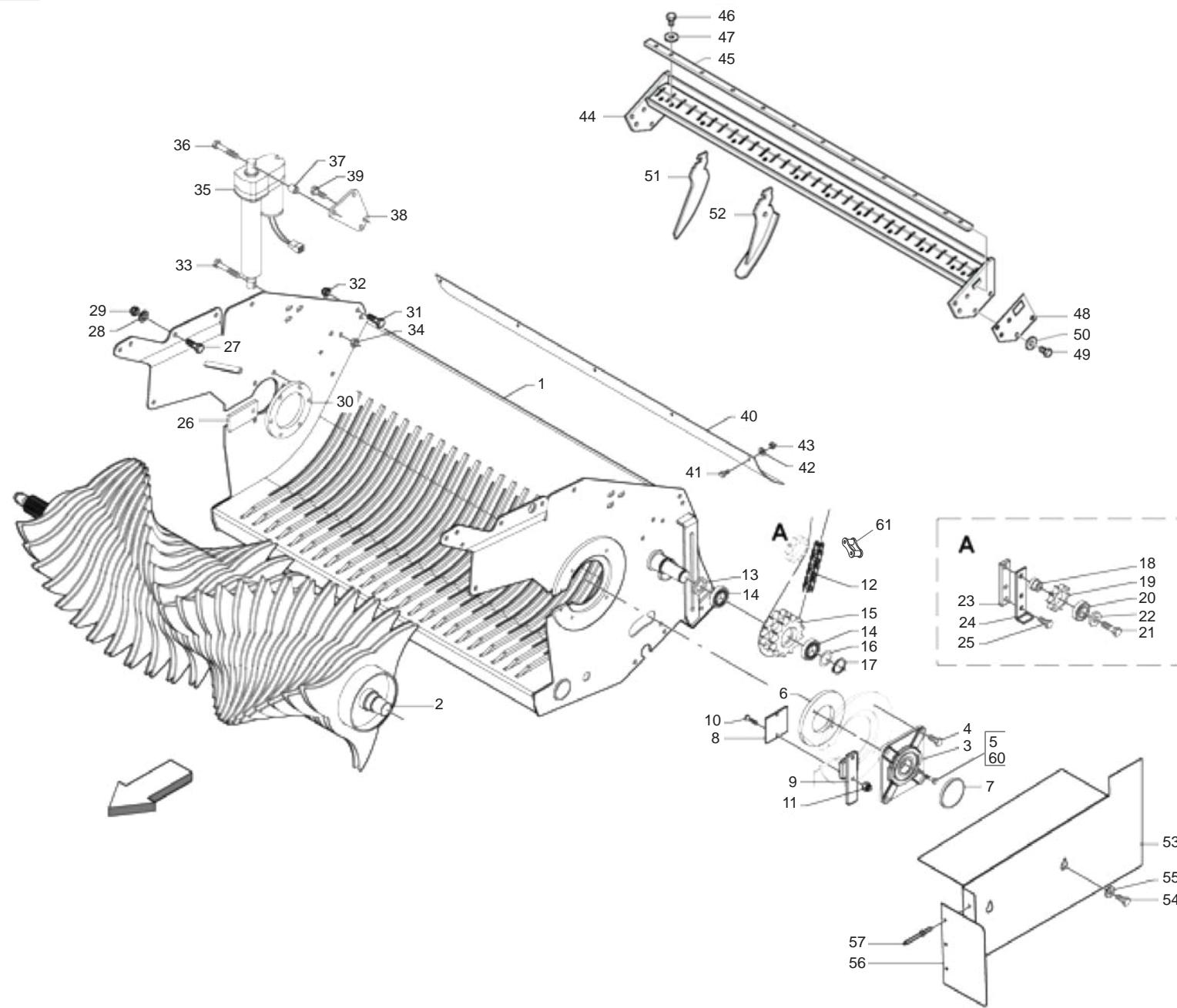
**CUT 25: TELAIO + ROTORE**
