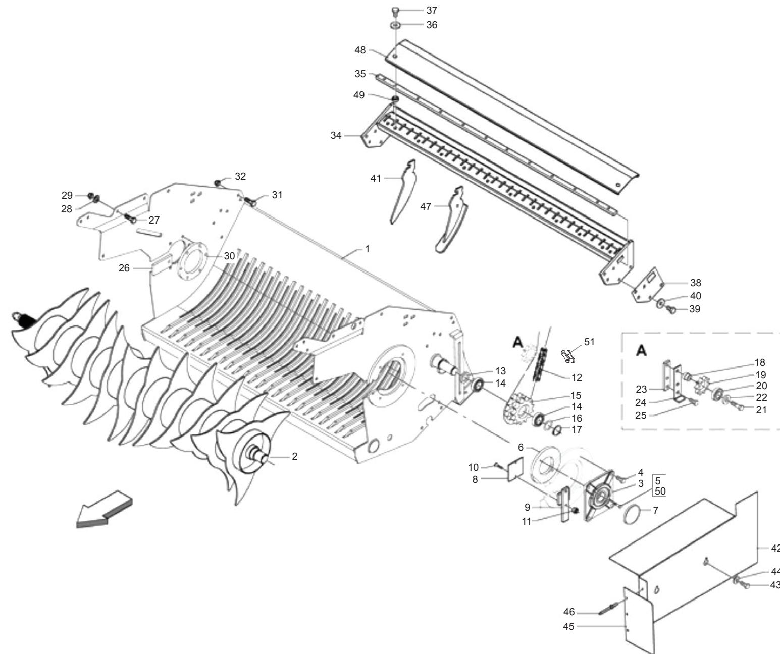
**ROTOR: TELAIO + ROTORE**
